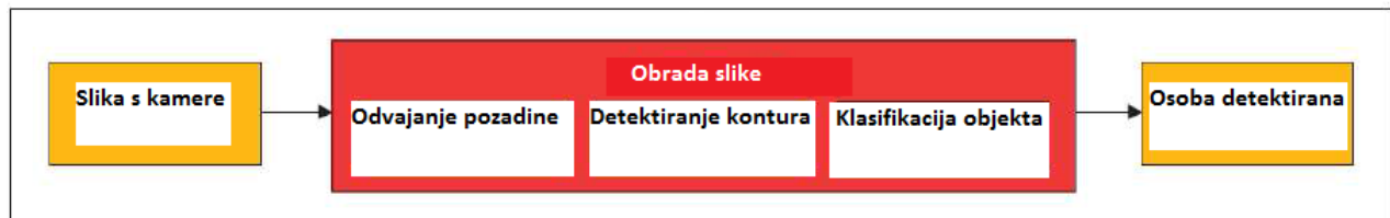
Sl.4.8. SWEETcam algoritam za detekciju objekata [5]
