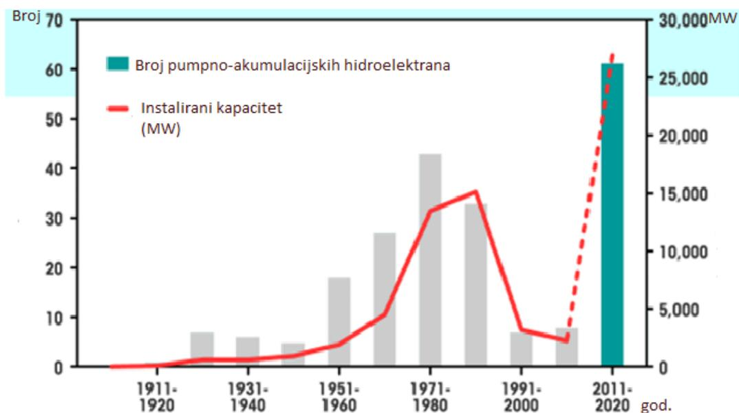
**Slika 5.4** Dijagram očekivanog povećanja kapaciteta pumpno-akumulacijskih hidroelektrana
