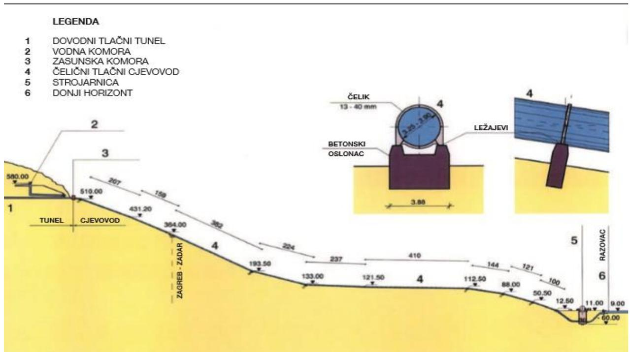
Slika 4.4. Poprečni prikaz čeličnog tlačnog cjevovoda
