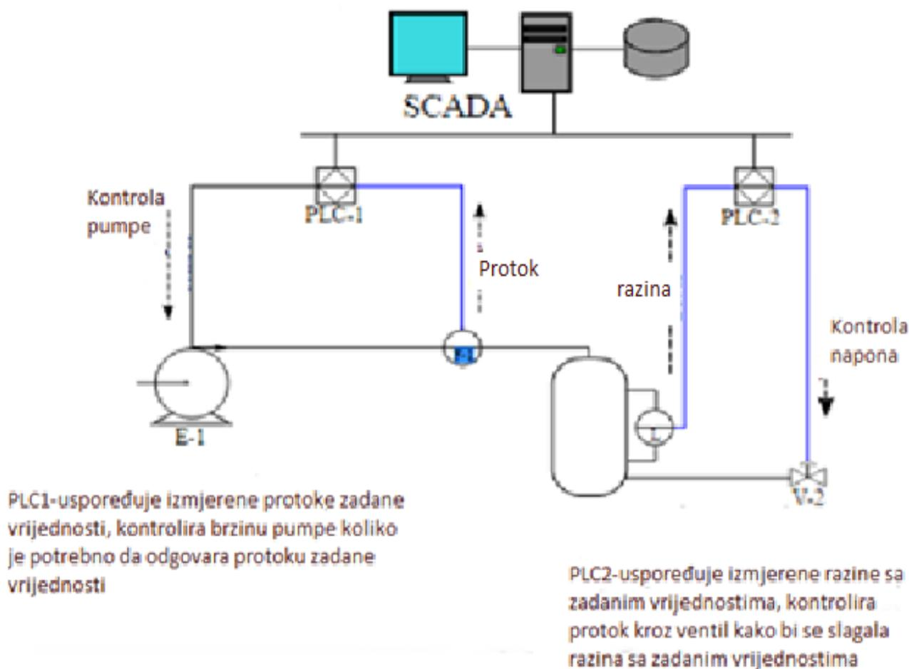
**Slika 3.8.** Shematski prikaz SCADA sustava
