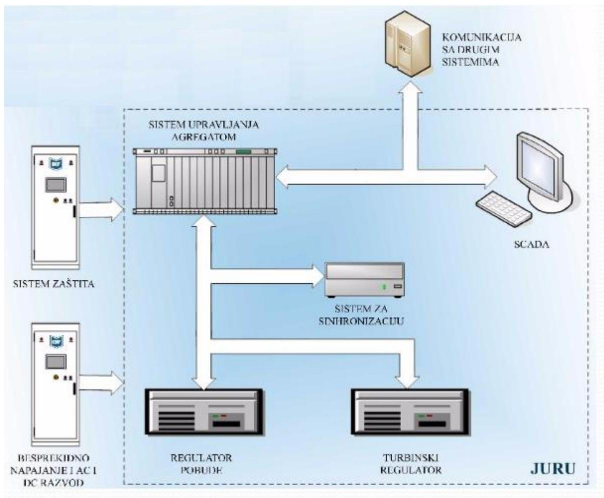
**Slika 3.9.** Blok dijagram centra za automatiku i regulaciju
