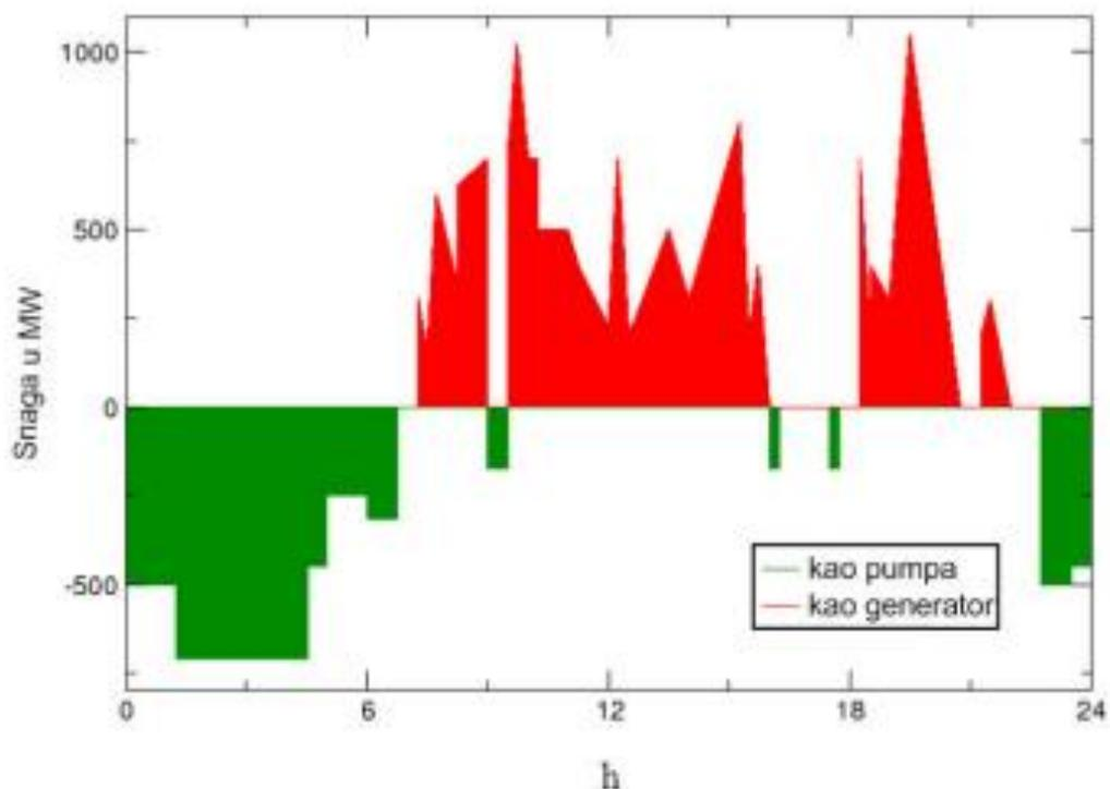
**Slika 4.12.** Dijagram potrošnje i proizvodnje električne energije
