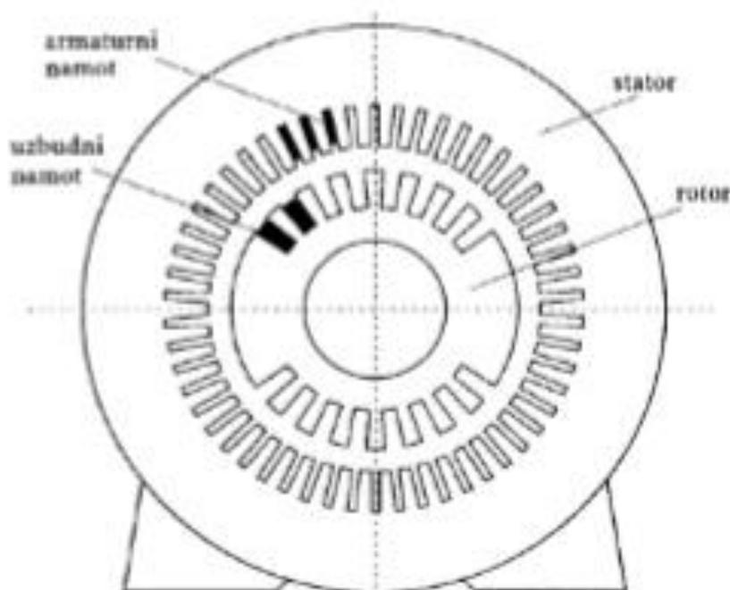
Slika 3.5. Presjek sinkronog stroja
