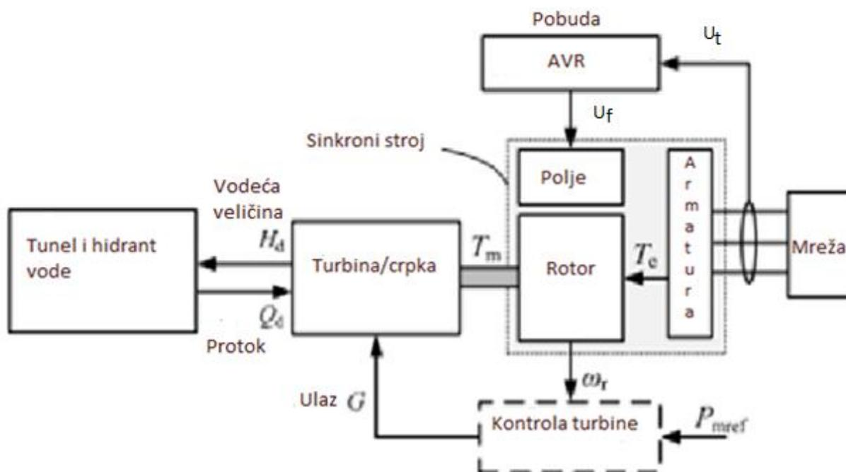
**Slika 3.3.** Blok dijagram pumpno-akumulacijske hidroelektrane
