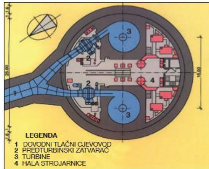
Slika 4.10. Pogled na halu strojarnice (od gore)
