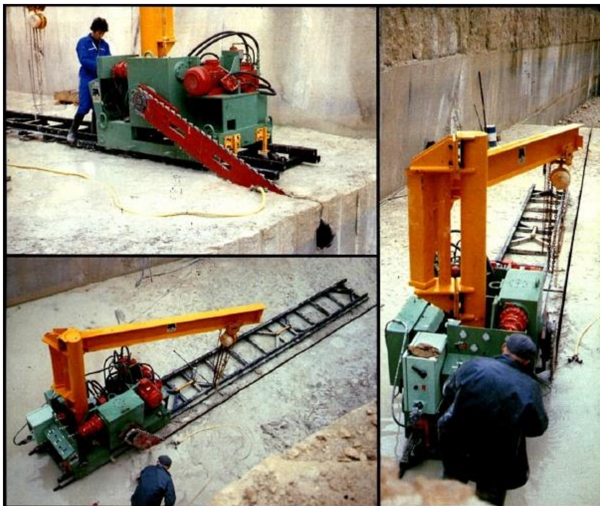
Slika 4.15. Lančana sjekačica u kamenolomu
