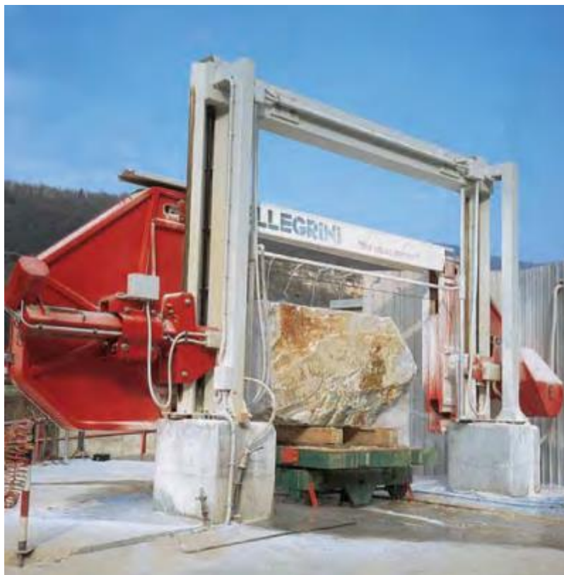
Slika 5.14. Filo sajla za rezanje kamena
