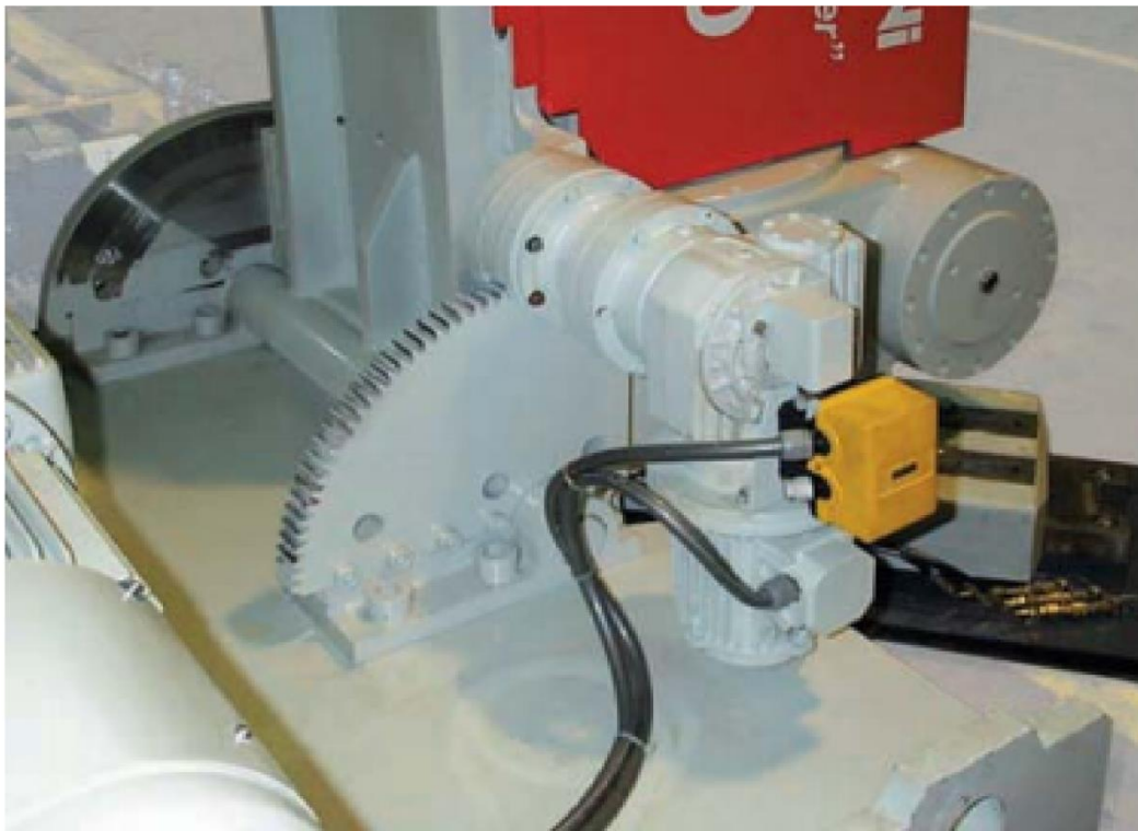
Slika 5.8. Motor za pozicioniranje pile
