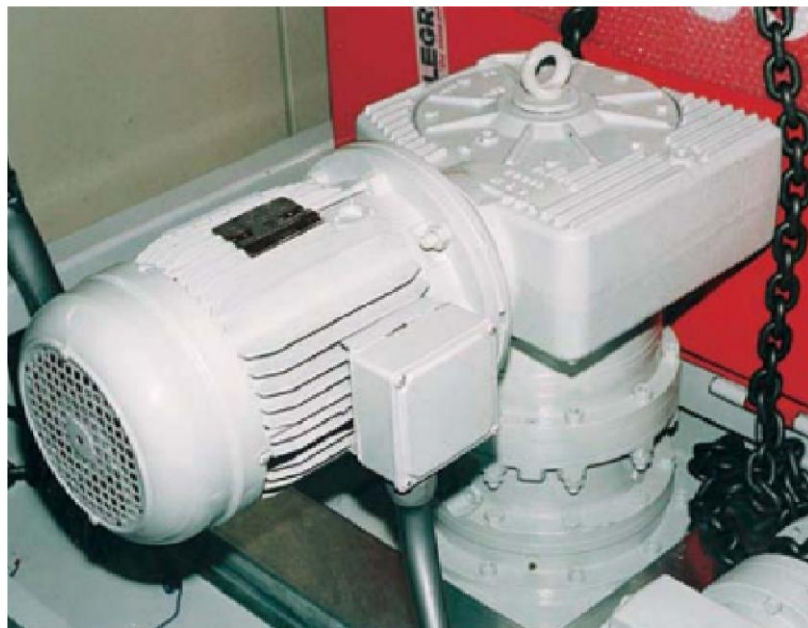
Slika 5.6. Motor za pomicanje sjekačice po tračnicama
