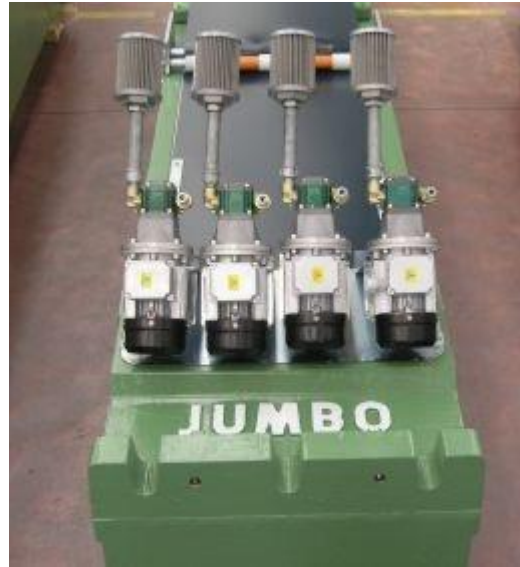
Slika 5.22. Pumpa za podmazivanje
