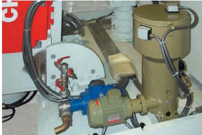
Slika 5.5. Motor za podmazivanje
