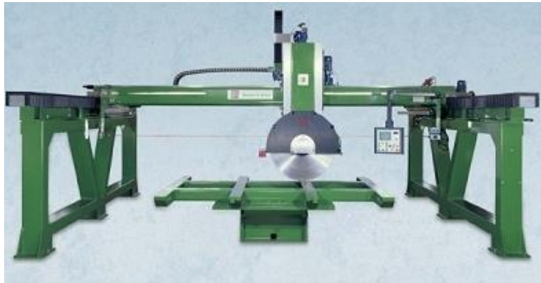
Slika 5.19. Freza za piljenje ploča tvrtke Bombieri & Venturi
