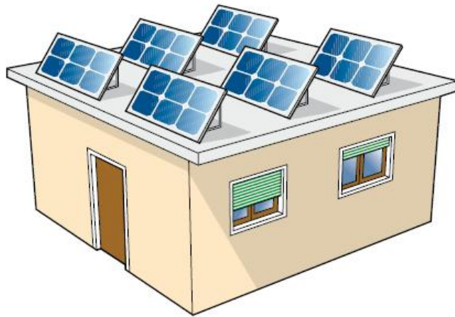
Slika 4.3. Fotonaponski sustav koji mijenja vanjski oblik zgrade [1]
