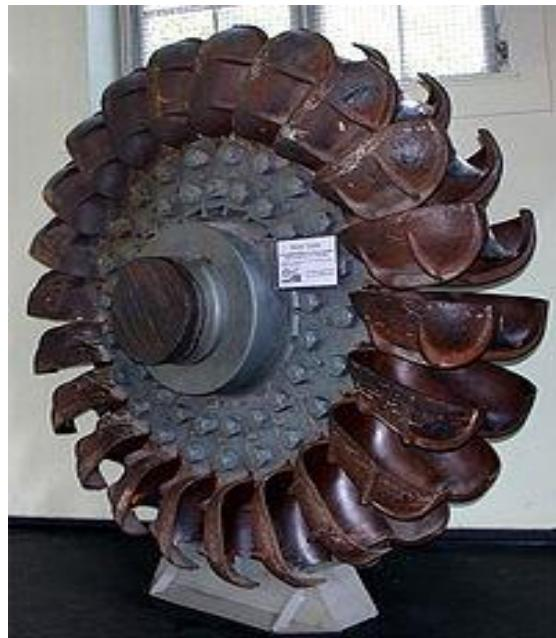
**Slika 3.5.** Peltonova turbina
