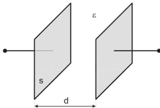
Slika 2.1 Presjek pločastog kapacitivnog senzora
