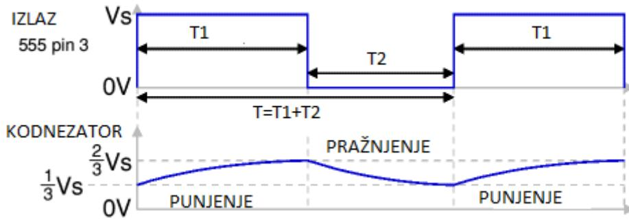
Slika3.2 Vremenski dijagram izlaznog signala NE555 timera [3]
