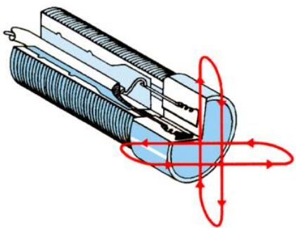
Slika 3.1. Beskontaktni senzor pomaka.
