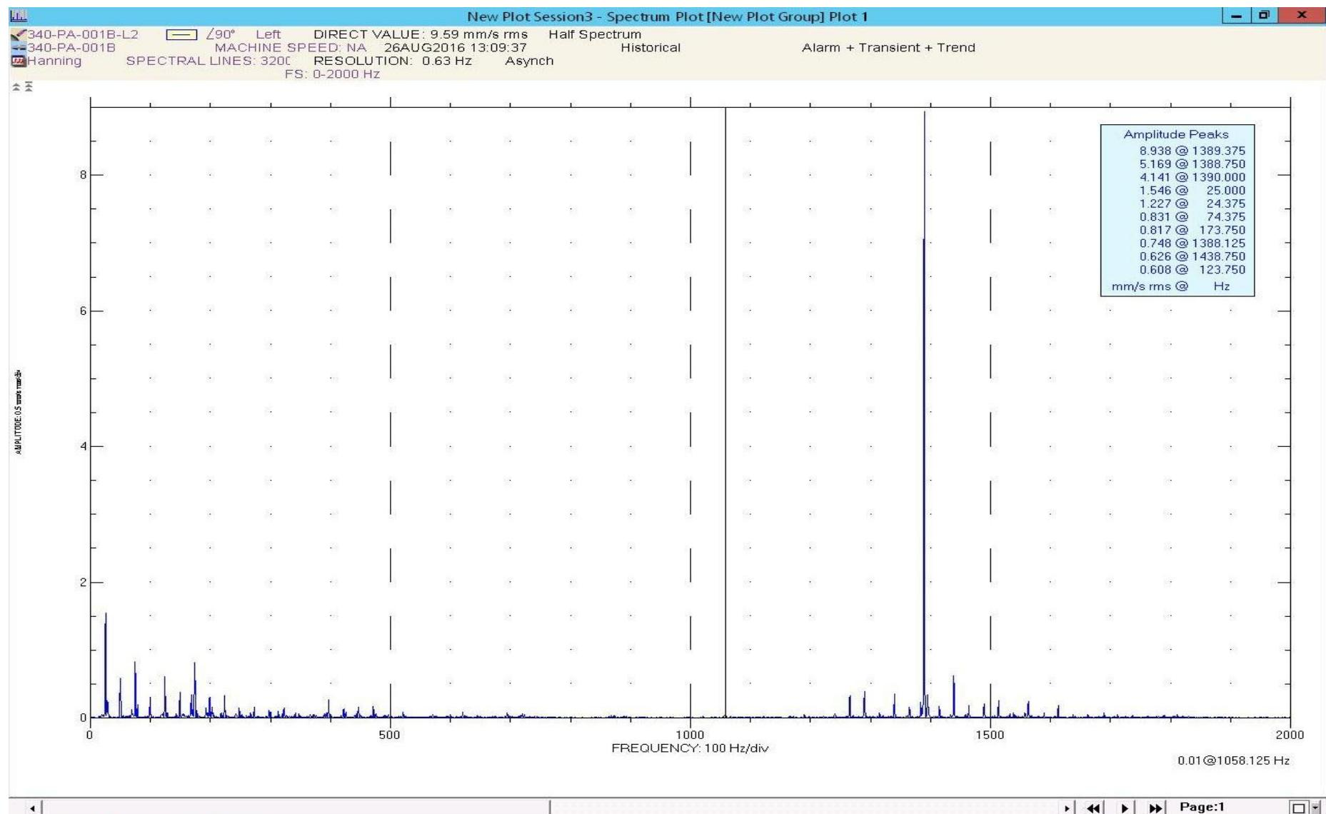
Slika 5.6. Frekvenčijski spektar dobiven mjeranjem vibracija na motoru sa više radnih sati.
