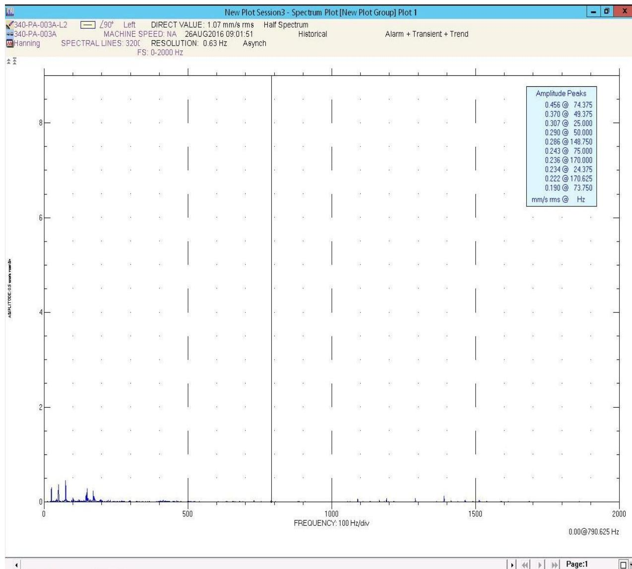
Slika 5.9. Frekvenijski spektar dobiven mjeranjem vibracija na motoru sa manje radnih sati.
