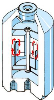
Slika 3.8. Kontaktni senzor brzine
