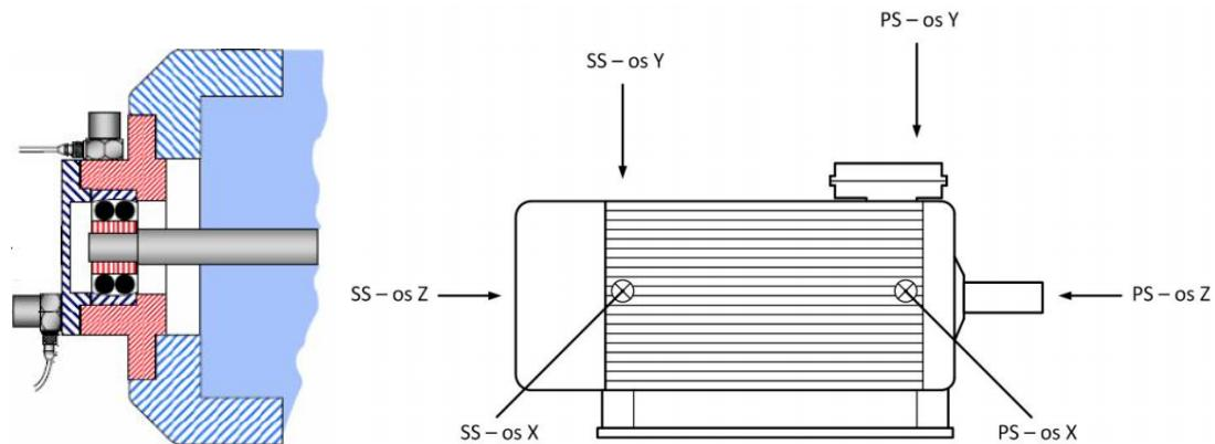
**Slika 4.2.** Pravilno postavljanje senzora za mjerjenje vibracija el. Strojeva [6].
