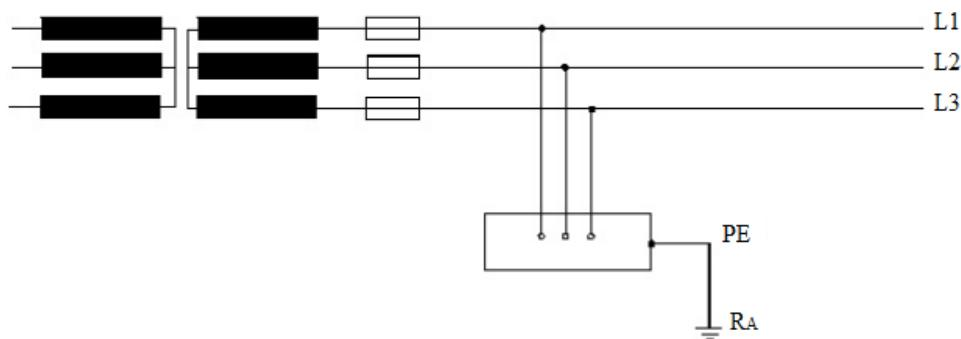
Sl. 3.5. IT sustav, izolirano zvjezdnište i uzemljena kućišta trošila, [2].
