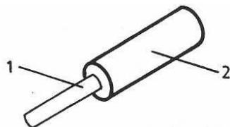
Sl. 4.1. zaštita izoliranjem, (1 - fazni vodič, 2 - izolacija), [4].
