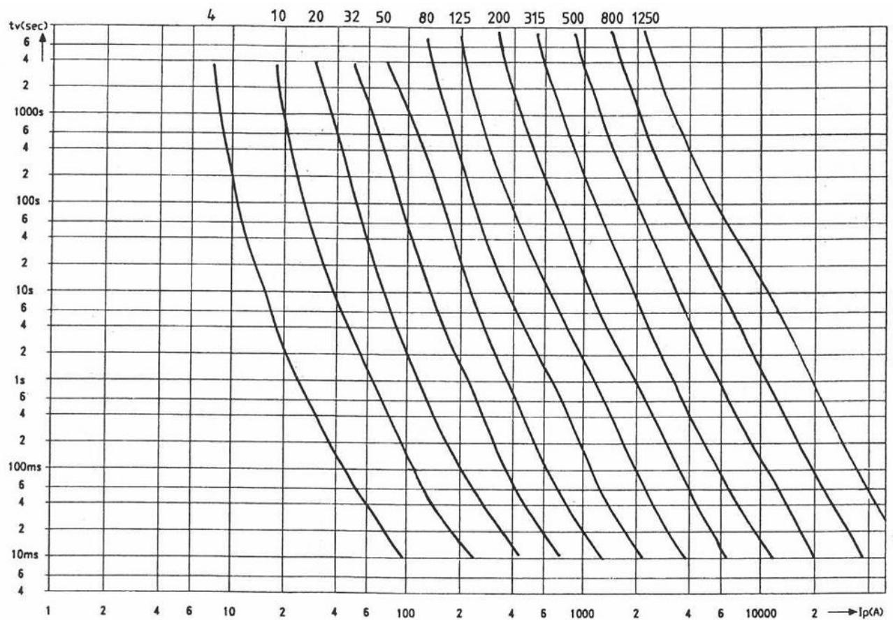
P.4.2. karakteristika automatskih instalacijskih prekidača.
