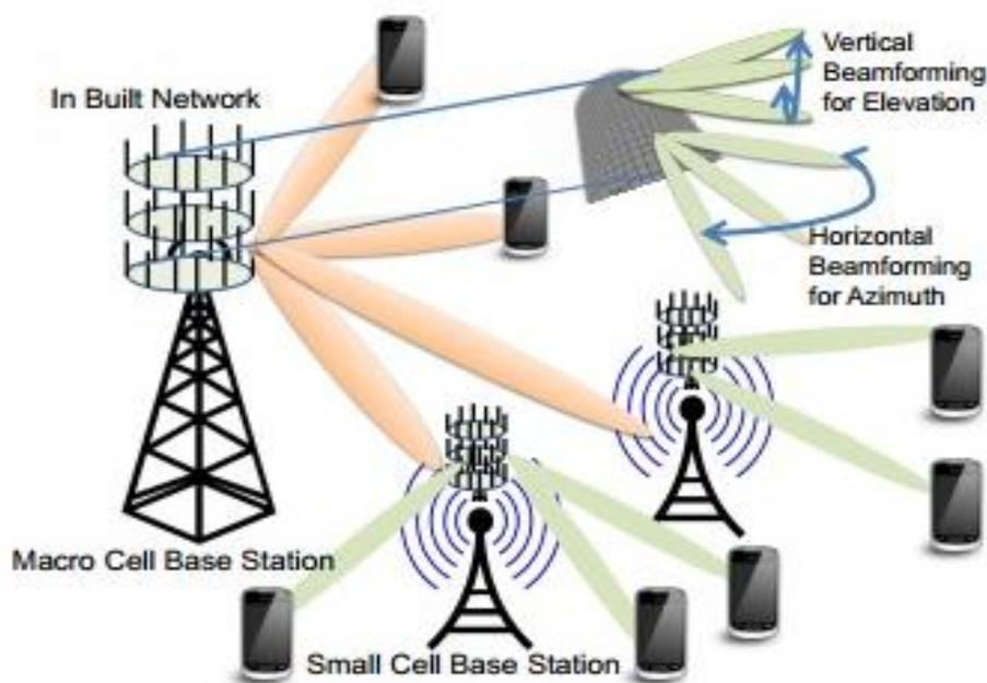
Slika 4.1.1. Masivni *MIMO* i formiranje snopova zraka [2]
