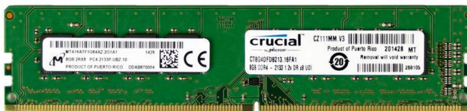
Slika 3.3.1: Prikazuje izgled radne memorije Crucial DDR4-2133 4GB (CT4G4DFS8213) [7]
