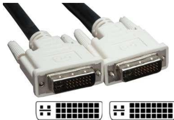
Slika 3.8.2.1. prikazuje izgled DVI kabla [19]
