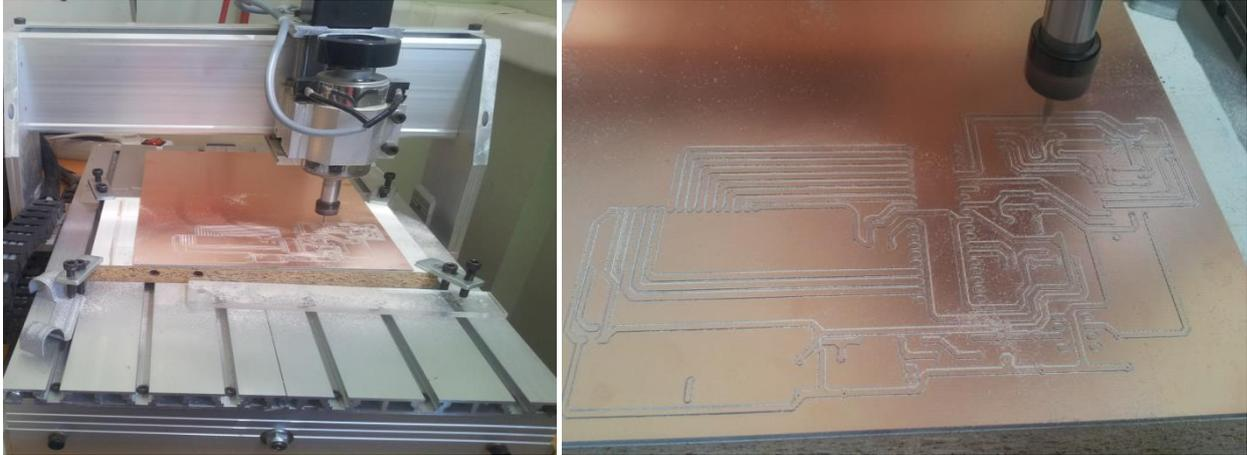
**Slika 3.23.** Izrada pločice
