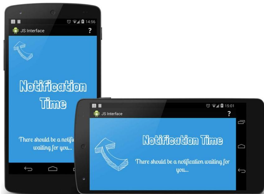
*Sl. 2.2. Prikaz prilagodbe aplikacije na mobilnom uređaju načinu korištenja samog uređaja (horizontalni/vertikalni položaj) na temelju očitavanja akcelerometra, [2]*
