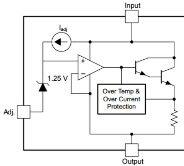
Slika 2.11. Blok dijagram LM317 pozitivnog prilagodljivog regulatora napona [7]
