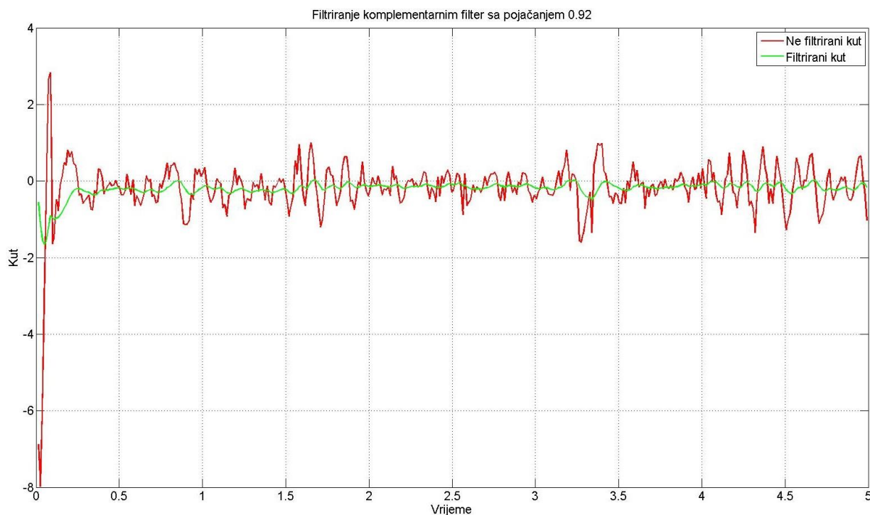
Slika 4.5. Komplementarni filter sa pojačanjem 0.92
