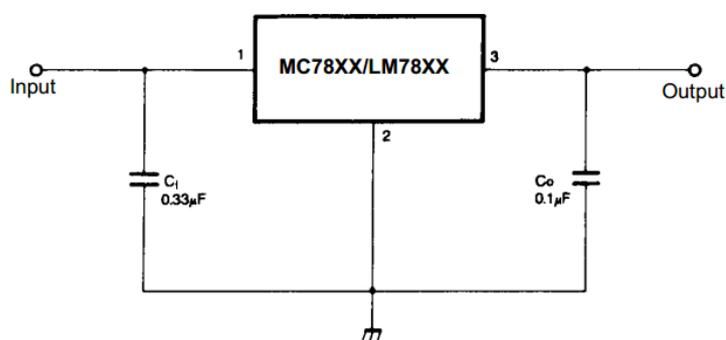
Slika 2.10. Primjena LM7805 regulatora napona na 5V [7]
