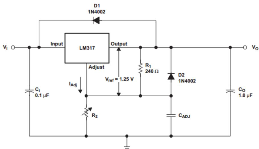
Slika 2.12. Primjena LM317 prilagodljivog regulatora napona [7]
