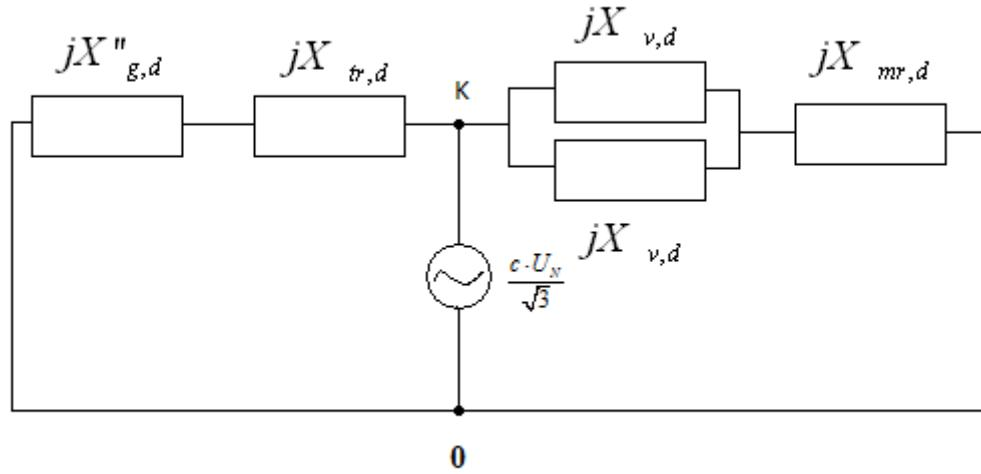
**Slika 4.2.** Shema direktnog sustava
