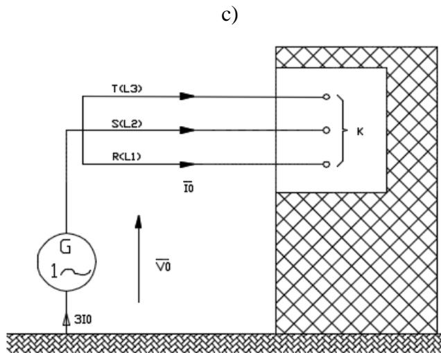
**Slika 3.5.** Strujni krugovi za mjerjenje direktne, inverzne i nulte impedancije komponentnih mreža s mjestu kratkog spoja
