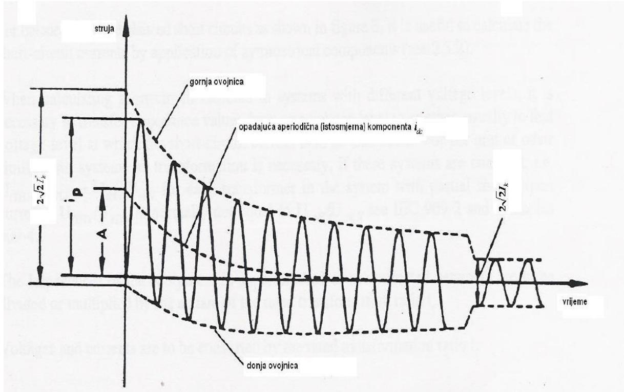
**Slika 3.2.** Struja kratkog spoja pri kratkom spoju blizu generatoru s opadajućom izmjeničnom komponentom
