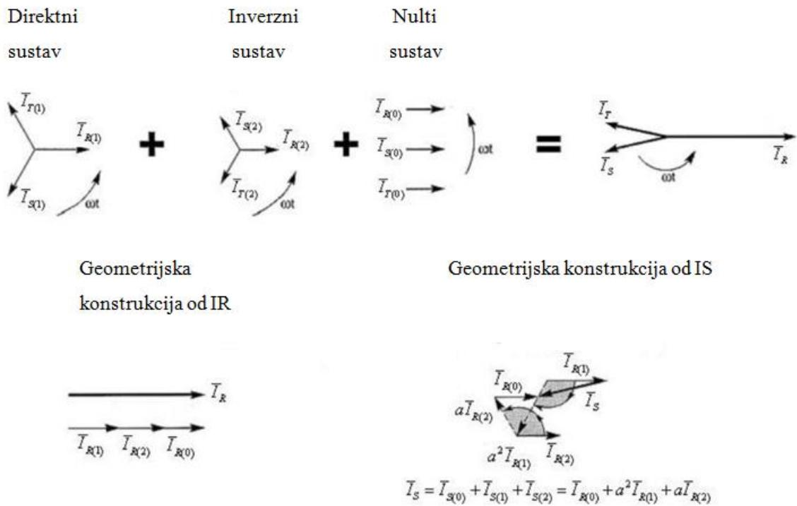
**Slika 3.4.** Nesimetrični sustav struja prikazan kao zbroj triju simetričnih sustava
