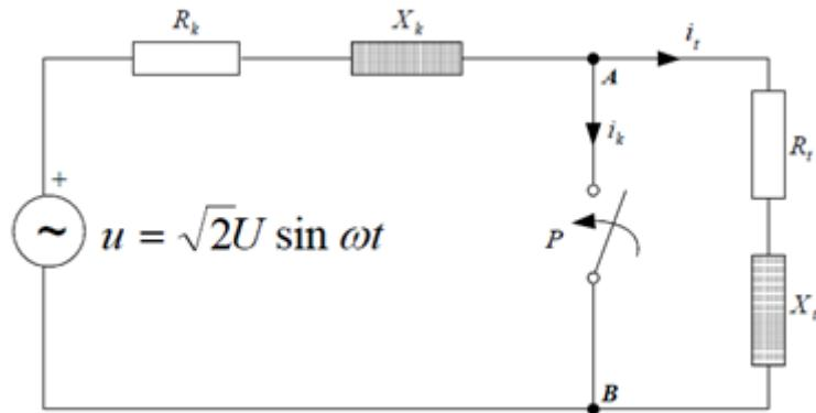
**Slika. 2.2.** Pojednostavljeni nadomjesni strujni krug za analizu kratkog spoja
