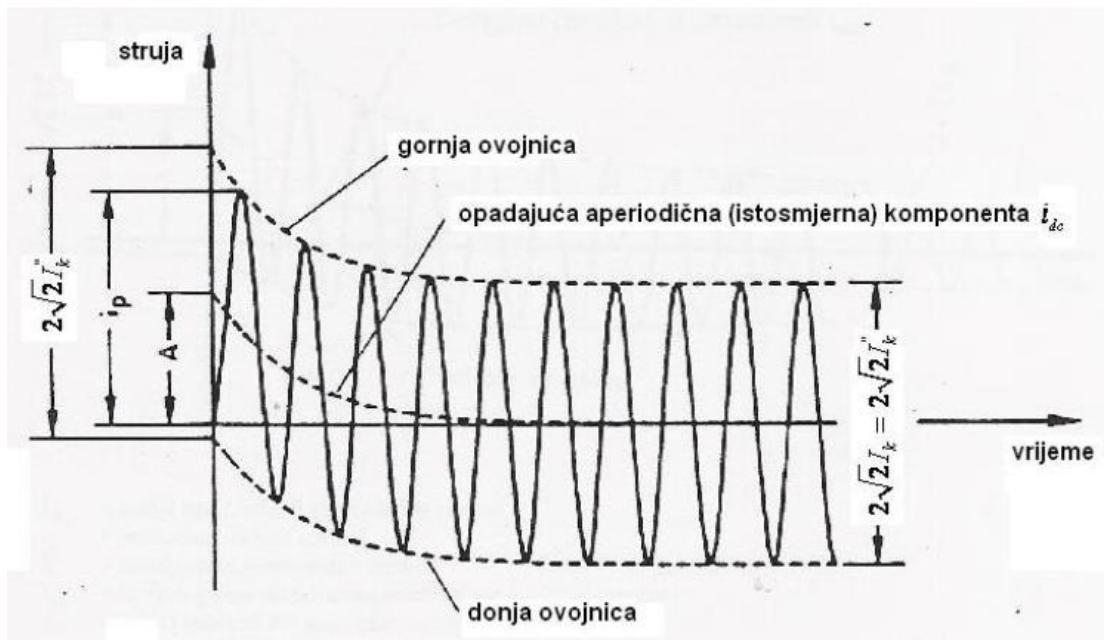
**Slika 3.1.** Struja kratkog spoja pri kratkom spoju daleko od generatora s konstantnom izmjeničnom komponentom
