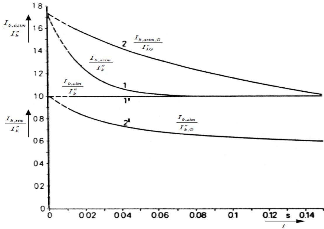
**Slika 2.3.** Vremenska funkcija asimetrične i simetrične rasklopne struje kratkog spoja relativno u odnosu na odgovarajuću subtranzijentnu struju 1, 1' - kratki spoj daleko od generatora, 2, 2' - kratki spoj blizu generatoru.
