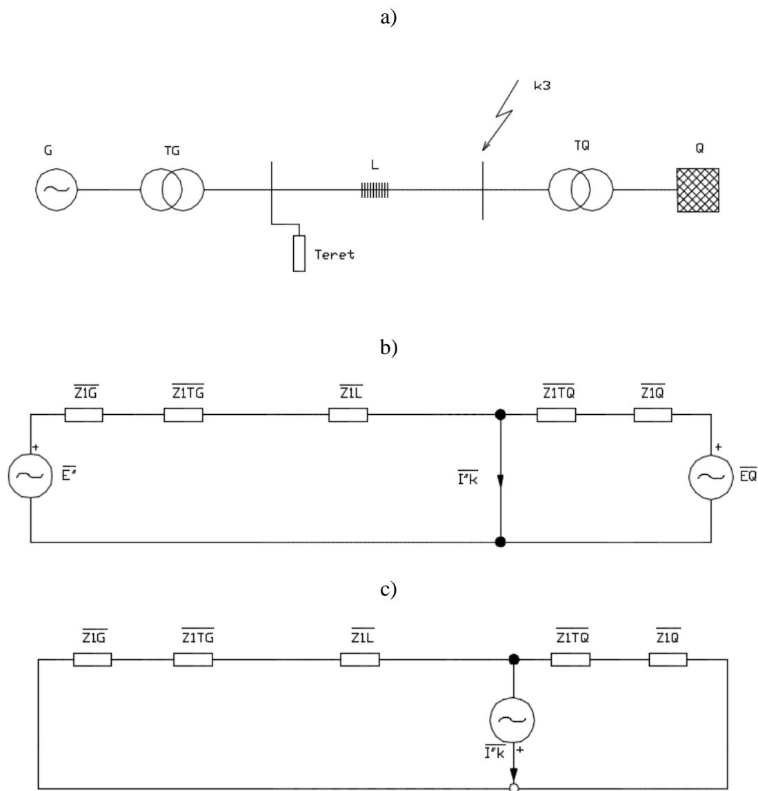
**Slika 3.3.** Ilustracija metode proračuna početne struje trofaznog kratkog spoja pri zanemarenju opterećenja
