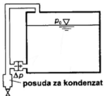
Slika 3.1.3 Mjerenje razine upotrebom diferencijalnog tlaka. [2]
