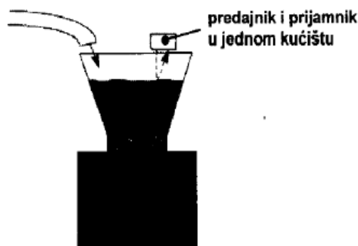
Slika 3.6.1 Lasersko mjerenje razine.[2]
