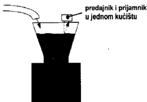
Slika 3.6.1 Lasersko mjerenje razine.[2]
