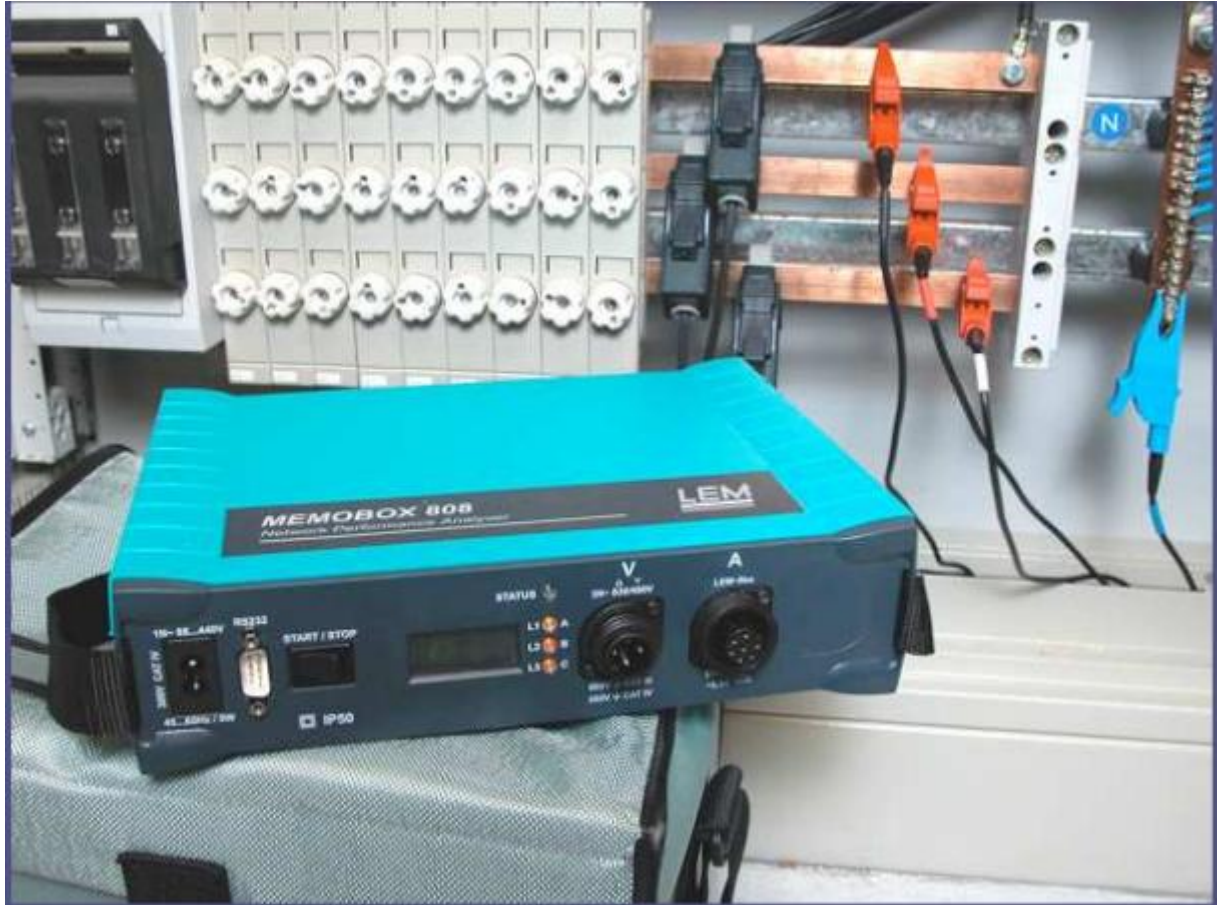
Slika 5.2. Uređaj Lem Memobox 808 [6]
