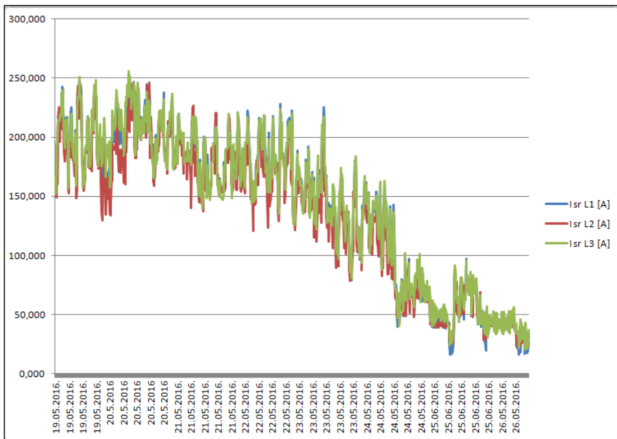
Slika 5.3. Graf mjerene struje na transformatoru u trajanju od 19.05.2016. do 26.05.2016.
