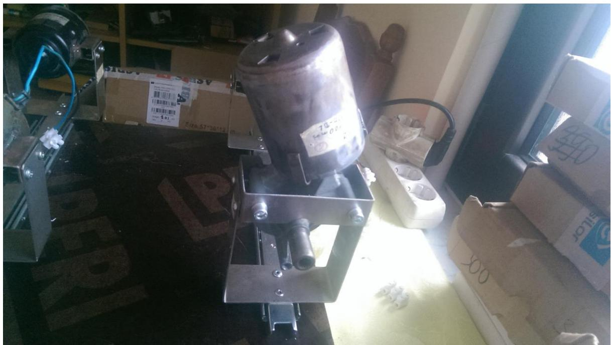
**Slika 6.15.** Četvrti testni motor (sa redukcijom) [21]
