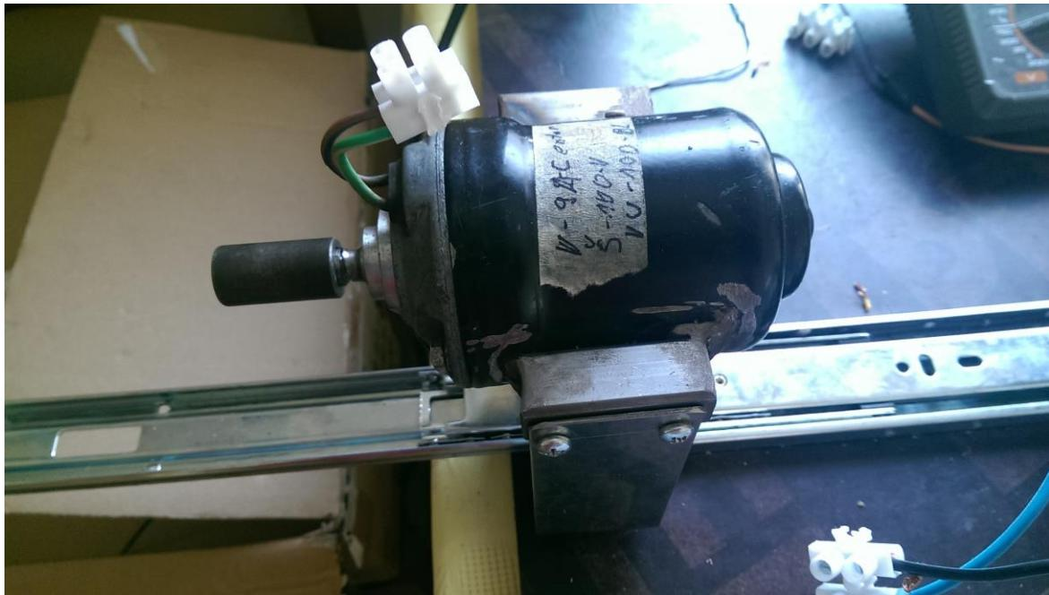
**Slika 6.12.** Prvi testni motor (istosmjerni) [21]
