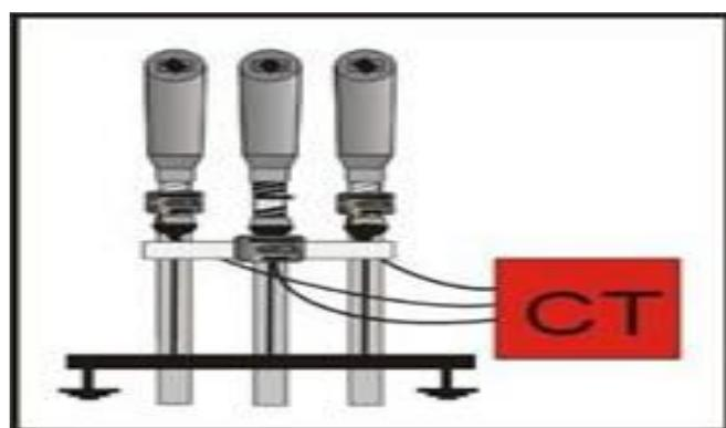
Slika 2.20. Senzori na kabelskim završetcima [8]
