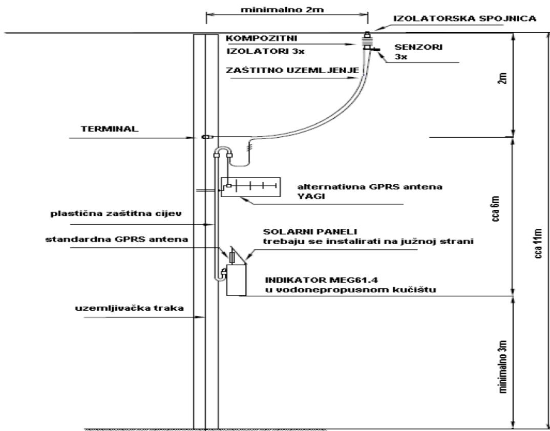
Slika 3.12. Način montaže i dijelovi indikatora kvara MEg61.4
