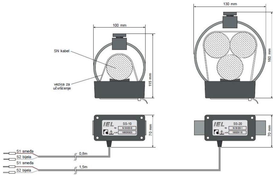
**Slika 2.9.** Način montaže senzora oko kabela [8]
