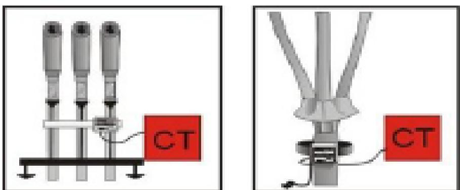
Slika 2.18. Senzori za jednožilne i višežilne kabele [8]
