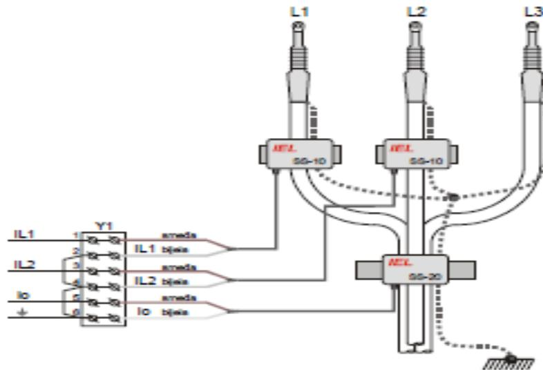
Slika 2.14. Način montaže senzora za struje dozemnog kvara manje od 20 A [7]
