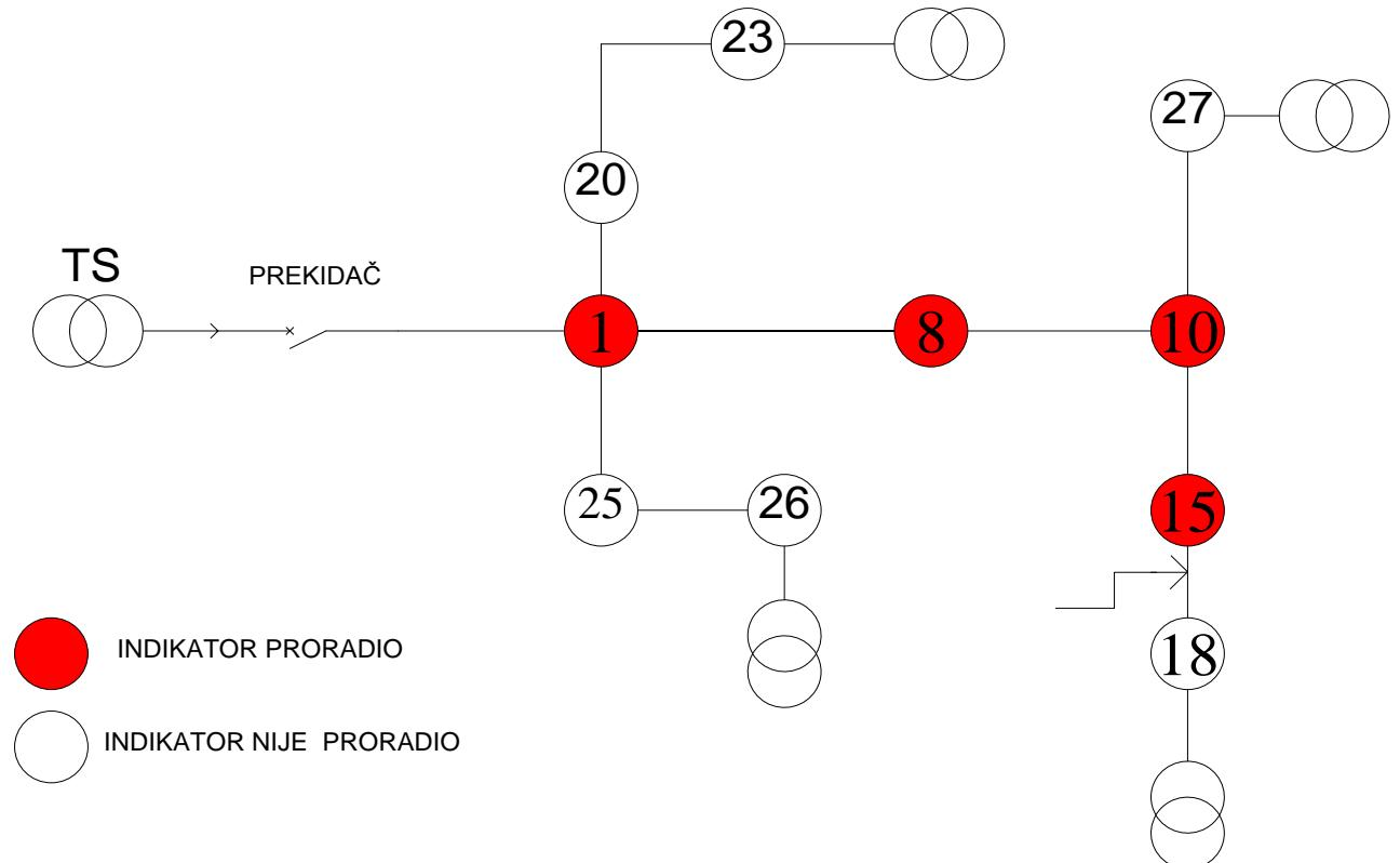
**Slika 2.1.** Djelovanje indikatora ugrađenih na stupove nadzemne mreže
