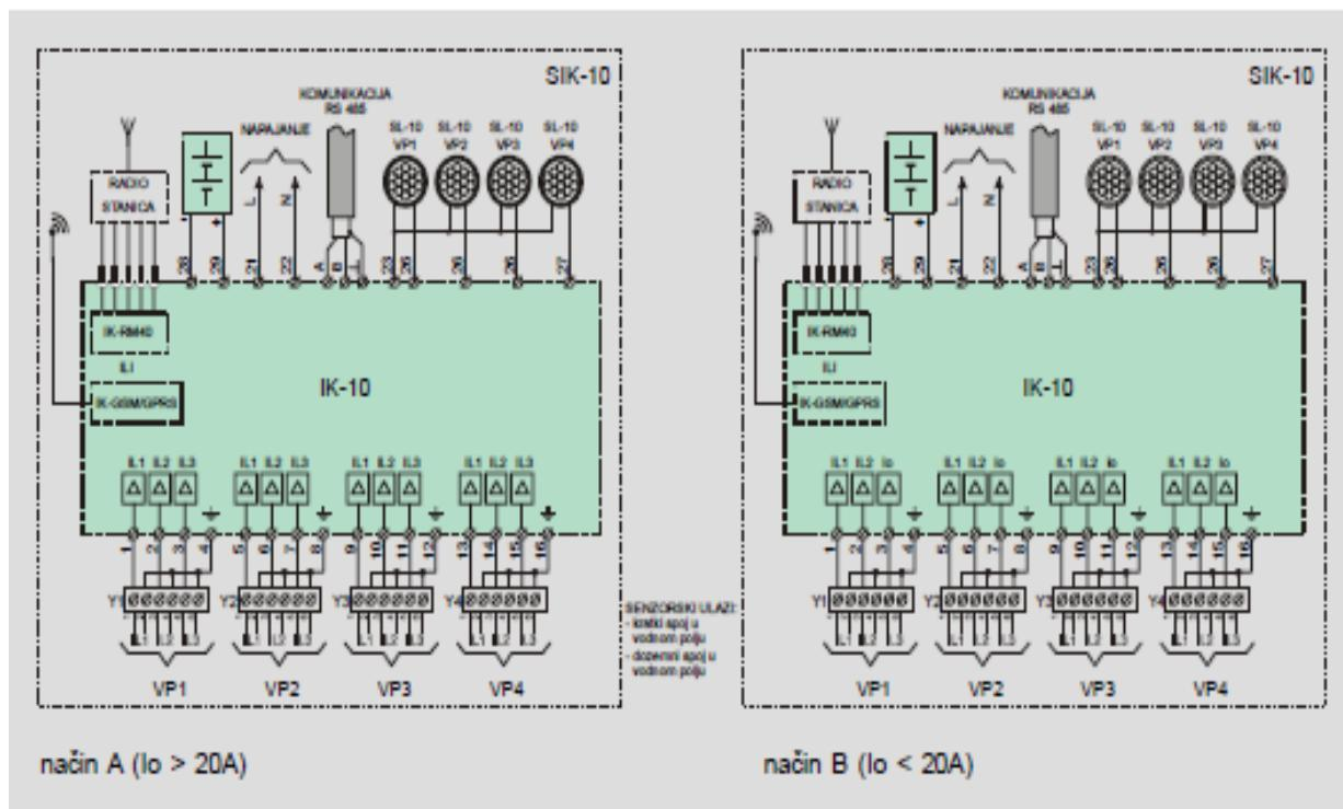
**Slika 2.16.** Plan priključaka sustava za indikaciju kvara SIK-10 [7]
