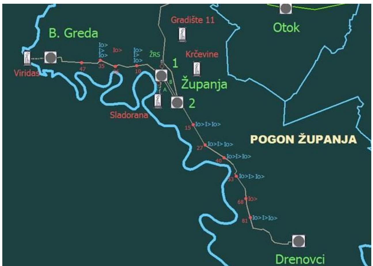
Slika 3.1. Indikatori kvara SIK-30 na 35 kV dalekovodima [13]
