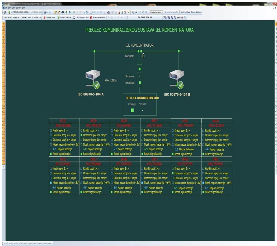
Slika 3.5. daljinska dojava kvara na ekranu GPRS/GSM modulom [13]
