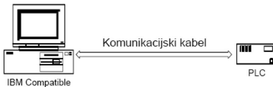
Slika 2.2. Komunikacija računala s PLC-om [4]
