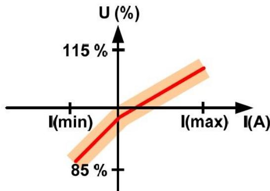
Slika 4.11. Usmjereno strujno zavisna karakteristika automatske regulacije napona [30]
