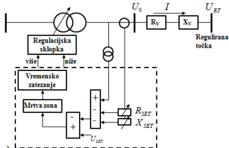
Slika 4.9. Shema regulacijskog transformatora sa strujnim mjernim transformatorom [27]
