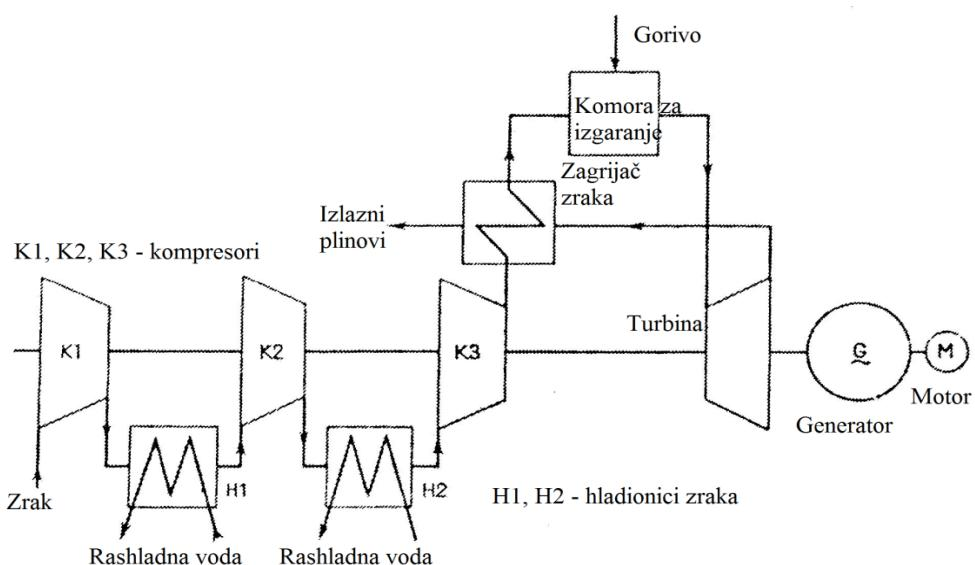
Sl. 3.6. Shema postrojenja s plinskom turbinom s trostupanjskom kompresijom i sa zagrijavanjem zraka.<sup>[9]</sup>
