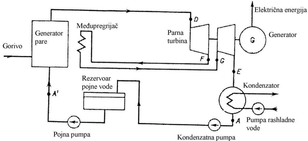
Sl. 3.4. Shematski prikaz procesa u parnoj termoelektrani s međupregrijanjem. [9]
