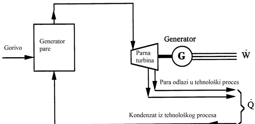
Sl. 3.3. Shematski prikaz protutlačne parne turbine.<sup>[12]</sup>
