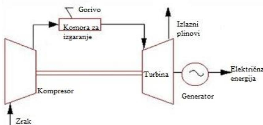
Sl. 3.5. Shematski prikaz procesa s plinskom turbinom.<sup>[13]</sup>
