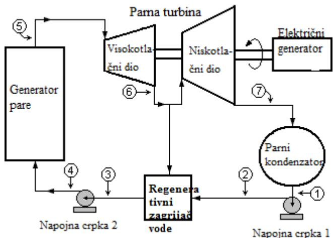
Sl. 3.1. Shematski prikaz procesa u parnoj termoelektrani.<sup>[10]</sup>
