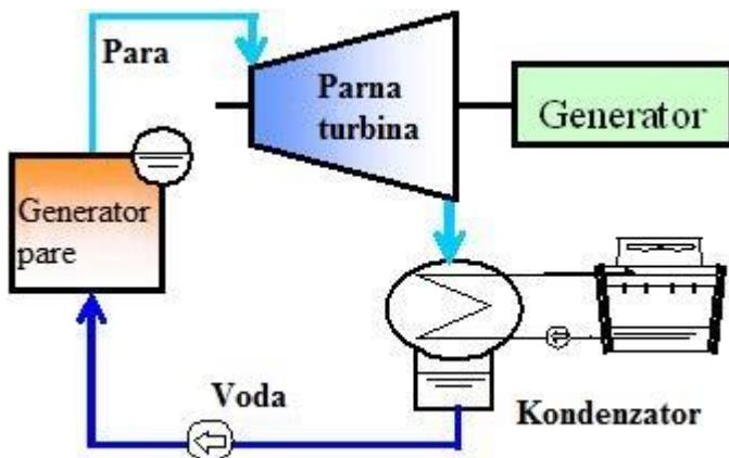
Sl. 3.2. Shematski prikaz kondenzacijske parne turbine.<sup>[11]</sup>
