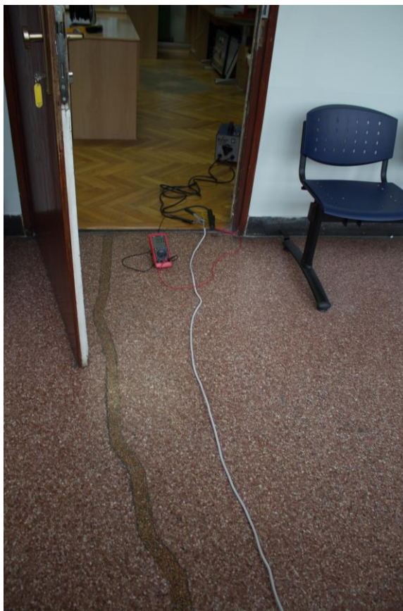
Slika 7.5. Simuliranje opterećenja nadžbukno postavljenog kabela
