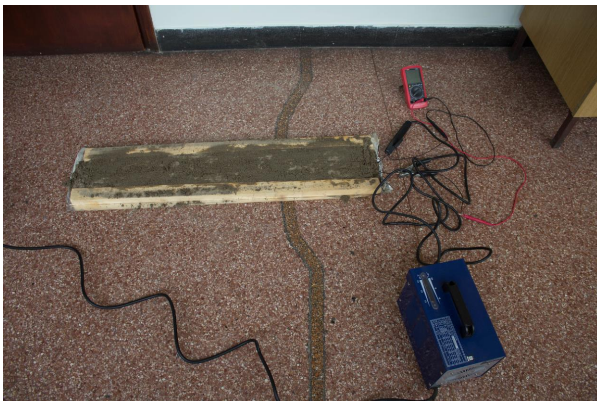
Slika 7.3. Simuliranje opterećenja podžbukno postavljenog kabela
