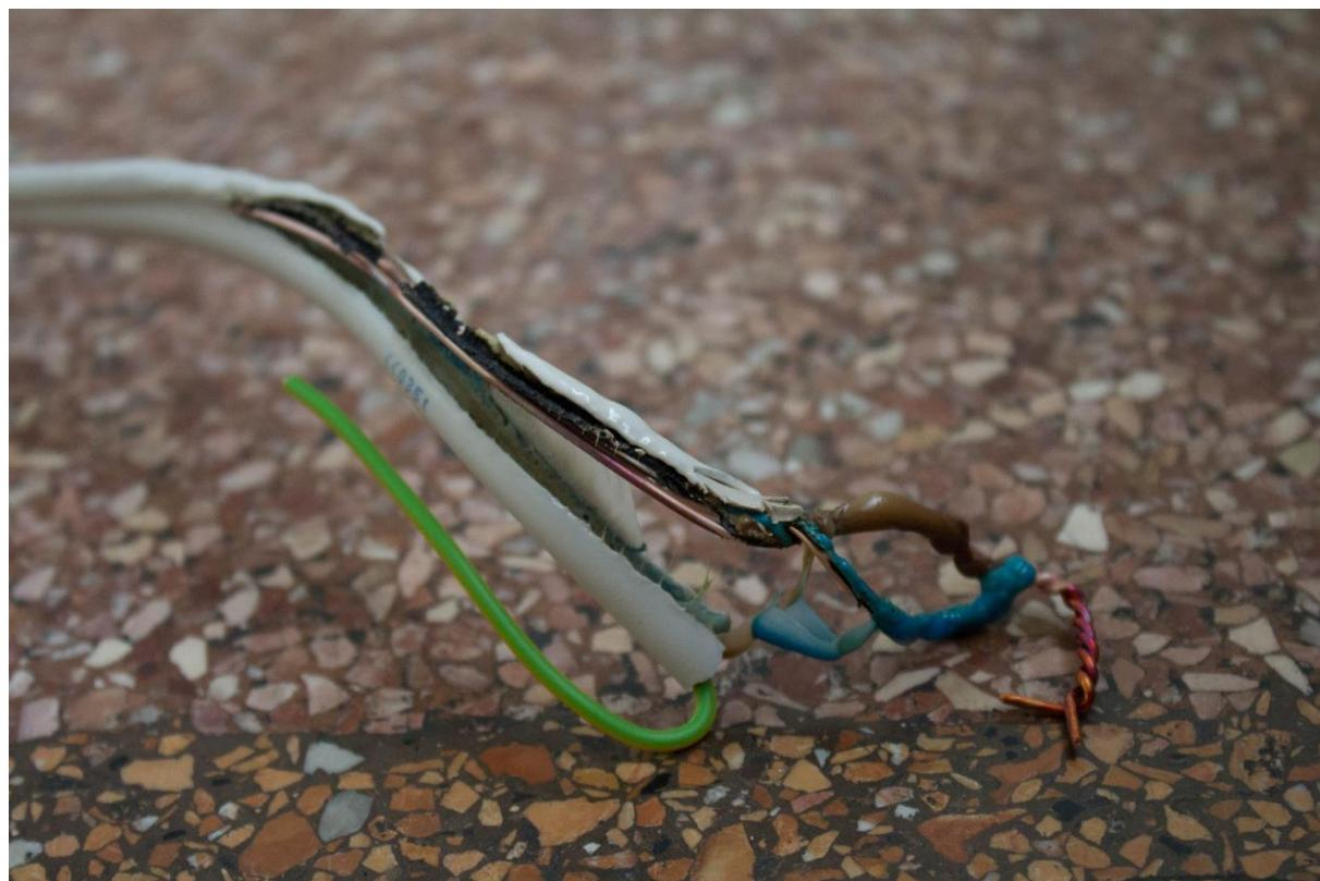
Slika 7.9. Vidno oštećena izolacija vodiča na kraju mjerena
