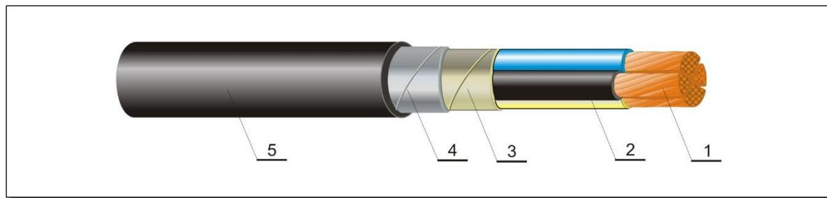
**Slika 3.7.** Prikaz energetskog i signalnog kabela armiranog s dvije čelične trake (XLPE izolacija)**Tablica 3.11.** Konstrukcija kabela tipa XP 41 i XP 41-A:
