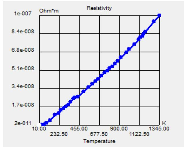
**Slika 8.2.** Krivulja ovisnosti električnog otpora o promjeni temperature
