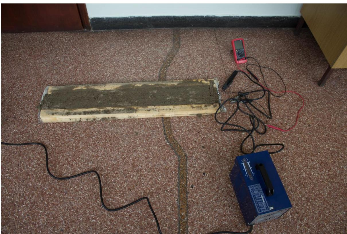
**Slika 7.3.** Simuliranje opterećenja podžbukno postavljenog kabela
