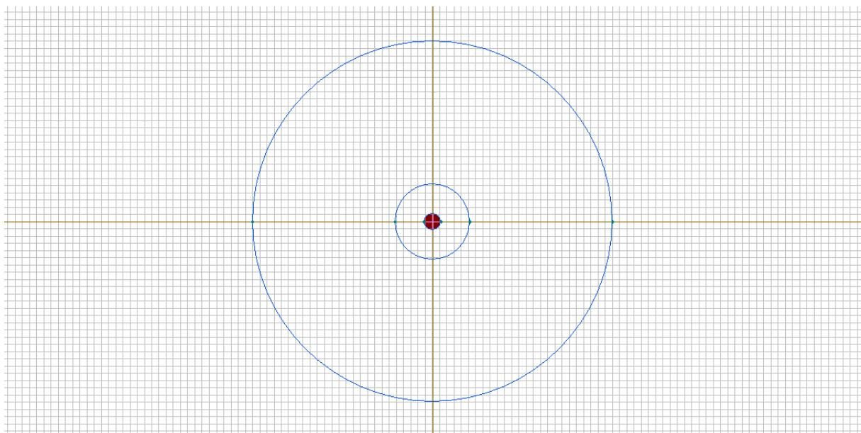
**Slika 6.4.** Model bakrenog vodiča izoliranog PVC izolacijom
