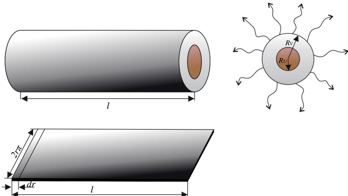
**Slika 6.1.** Prikaz električnog kabela korištenog u toplinskom proračunu uz pripadajuće oznake
