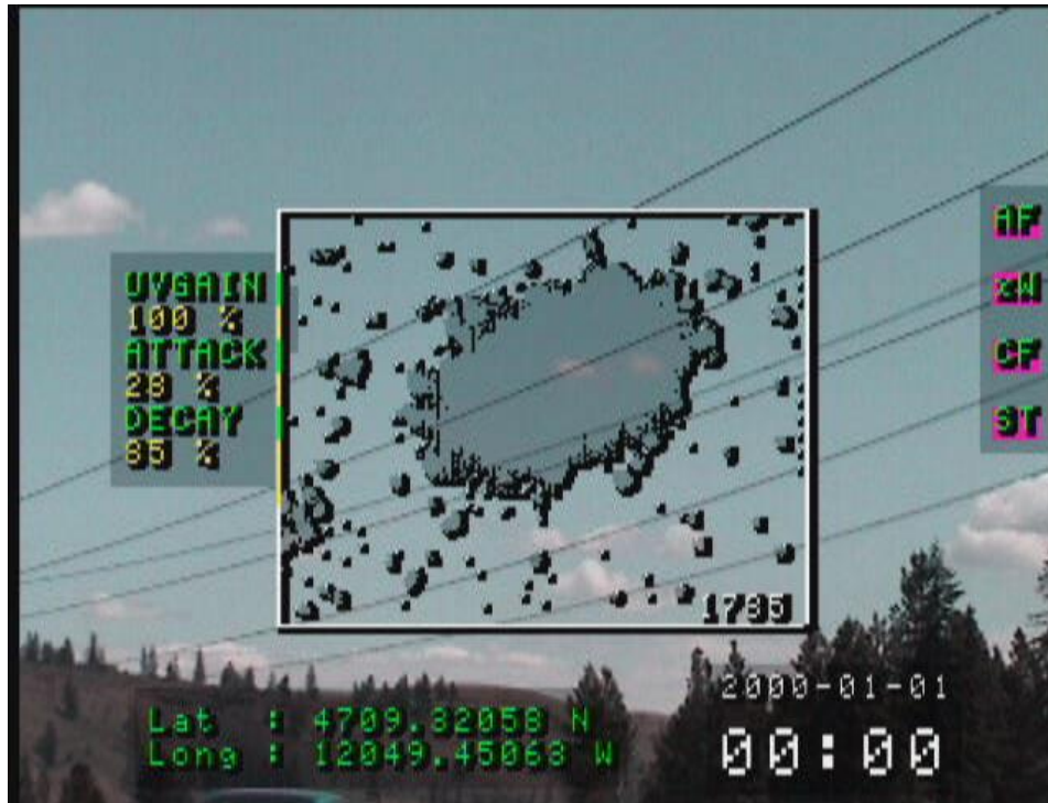
Slika 8.15. Prikaz korone između vodiča pomoću „Korona kamere“
