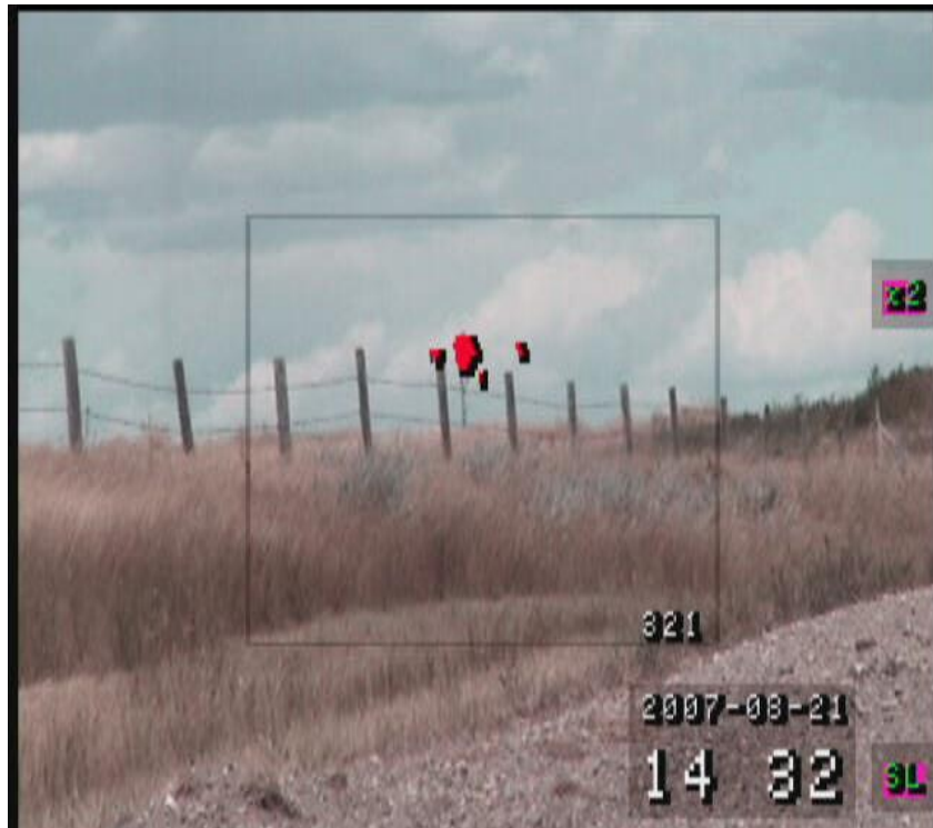
Slika 8.6. Prikaz korone na slici UV kamerom
