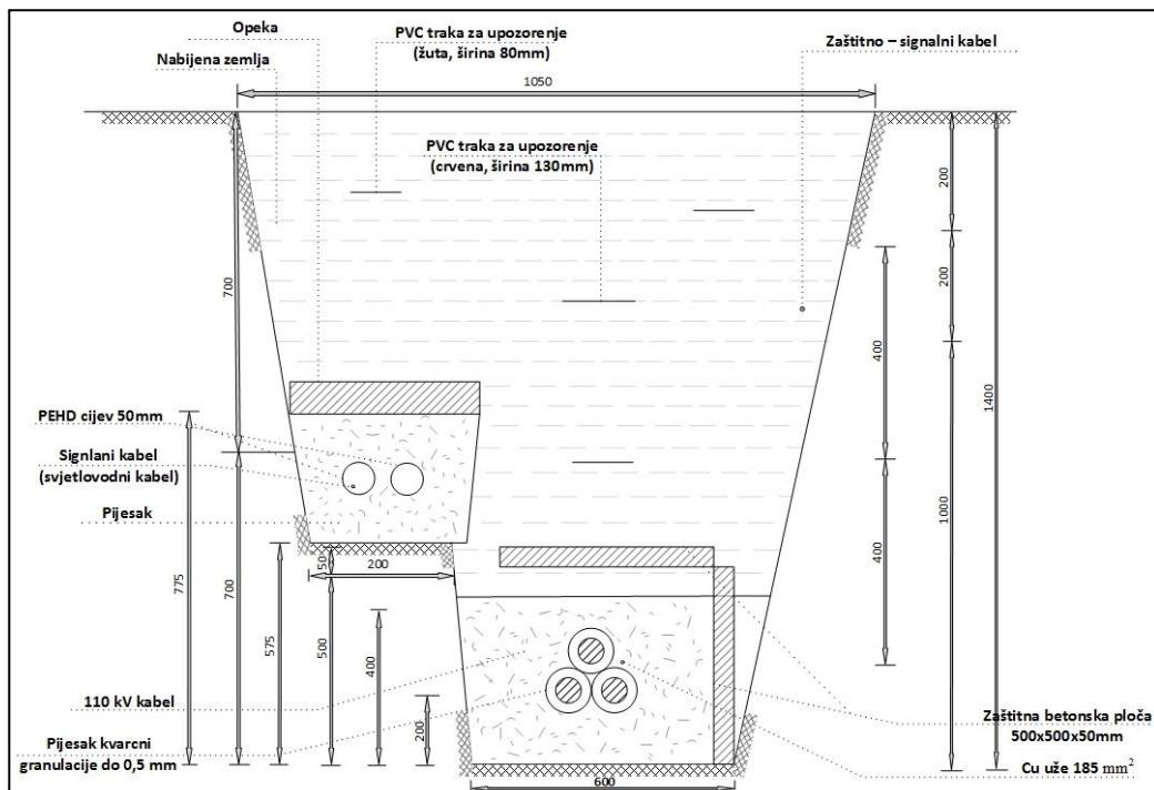
**Slika 4.3.** Presjek kabelskog rova za polaganje 110 kV kabela u zemlju
