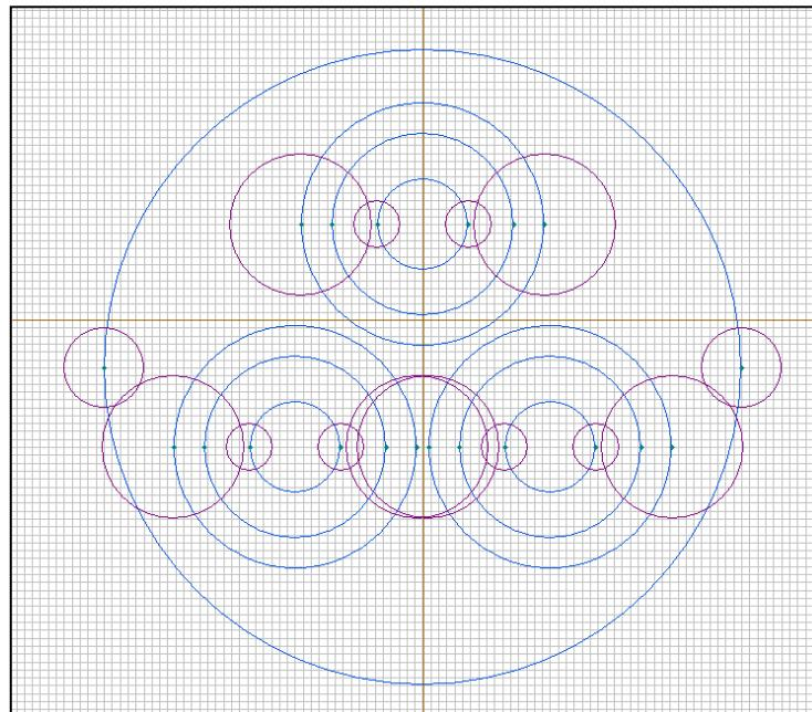
**Slika 6.4.** Model korišten za proračun temperature vodiča
