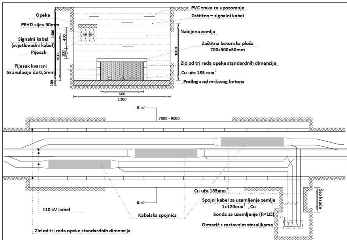
Slika 4.4. Skica mjesto spajanja 110 kV kabela s uzemljenjem
