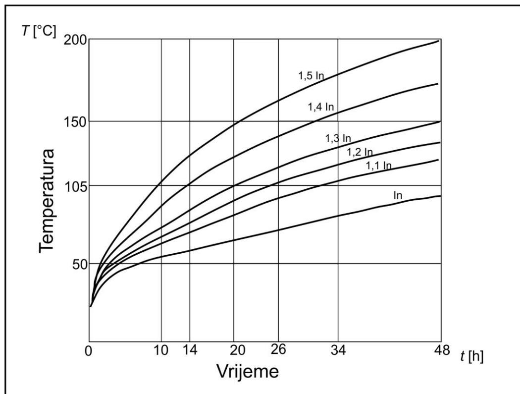
**Slika 6.13.** Temperatura vodiča pri prethodnom opterećenju 40 % In i promjenjivoj termičkoj otpornosti tla
