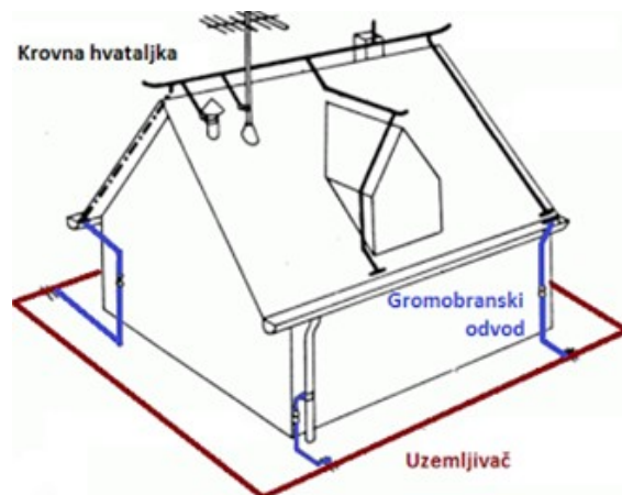
Slika 2.2. Izvedba gromobranskog uzemljenja na primjeru kuće
