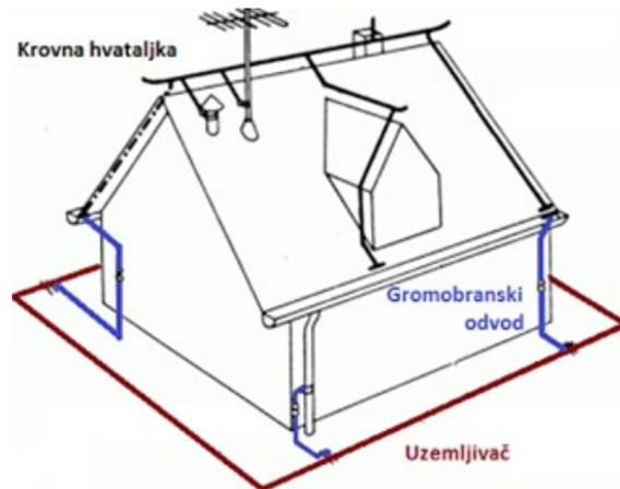
**Slika 2.2.** Izvedba gromobranskog uzemljenja na primjeru kuće
