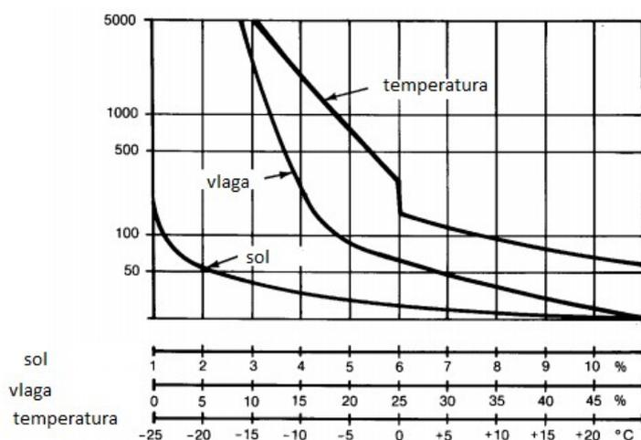
**Slika 3.3.** Ovisnost otpornosti tla  $\rho_z$  od postotka soli, vlage i temperature
