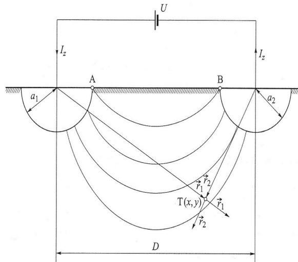
**Slika 5.2.** Dva polukuglasta uzemljivača položena na površini zemlje
