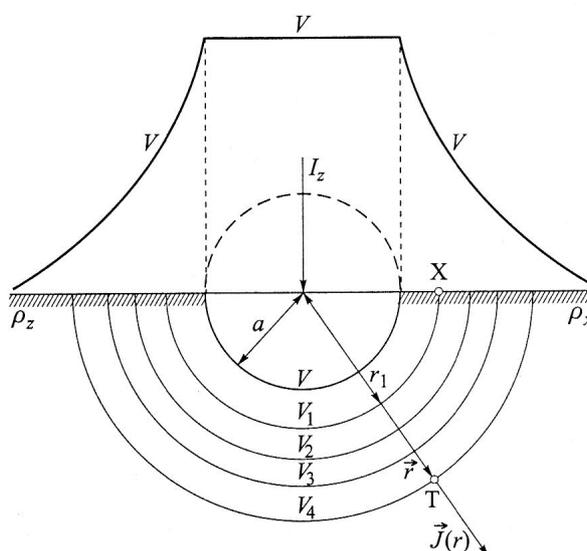
Slika 5.1. Razdioba potencijala za uzemljivač u obliku kugle
