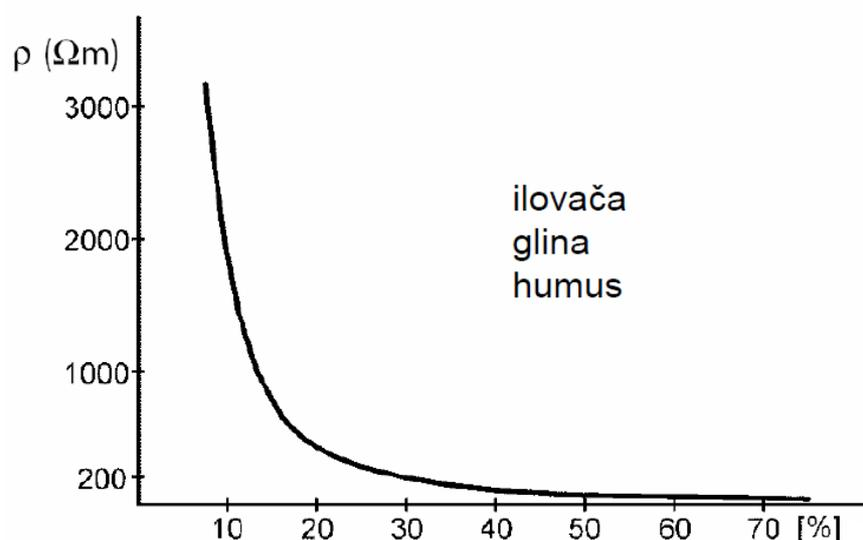
**Slika 3.1.** Ovisnost specifičnog otpora tla o vlažnosti
