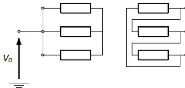
**Slika 2.7.** Zvijezda- trokut spoj (Yd) s neuzemljenim zvjezdlištem
