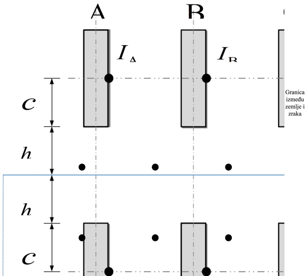
Slika 6.4. Raspored točaka u kojima se računa potencijal
