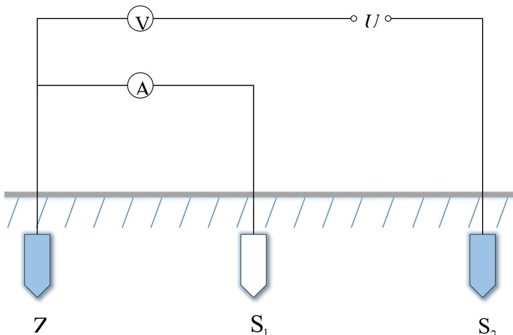
Slika 3.6. Mjerenje otpora uzemljenja U-I metodom
