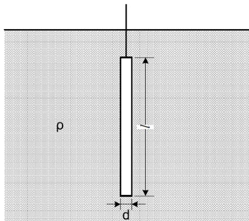
Slika 5.4. Štapni uzemljivač
