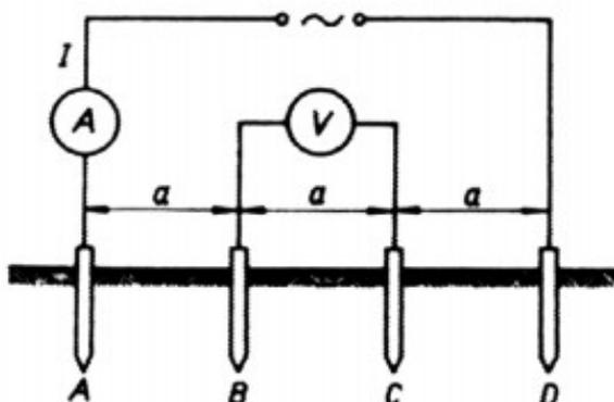
Slika 3.4. Mjerenje specifičnog otpora tla
