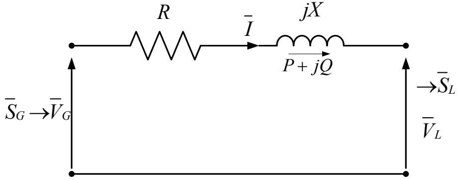
Sl. 2.1. Pojednostavljeni električni model izvora i potrošača, [4]
