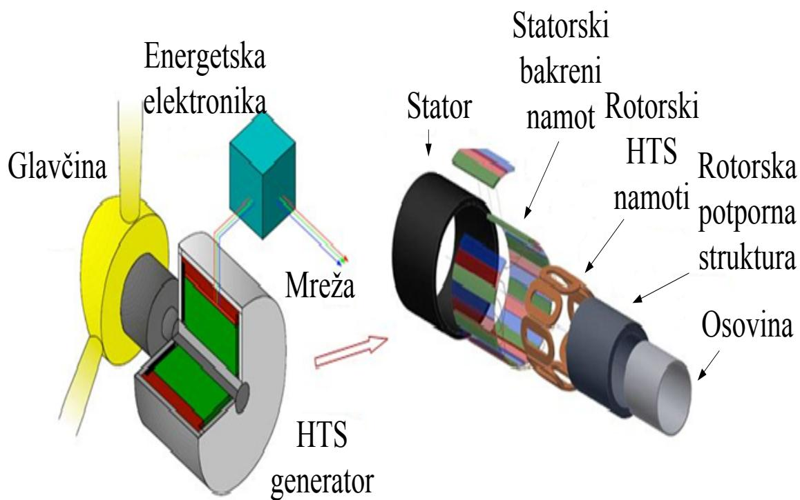
**Sl. 4.7** Prikaz visoko temperaturnog supravodljivog generatora (HTS), [12]
