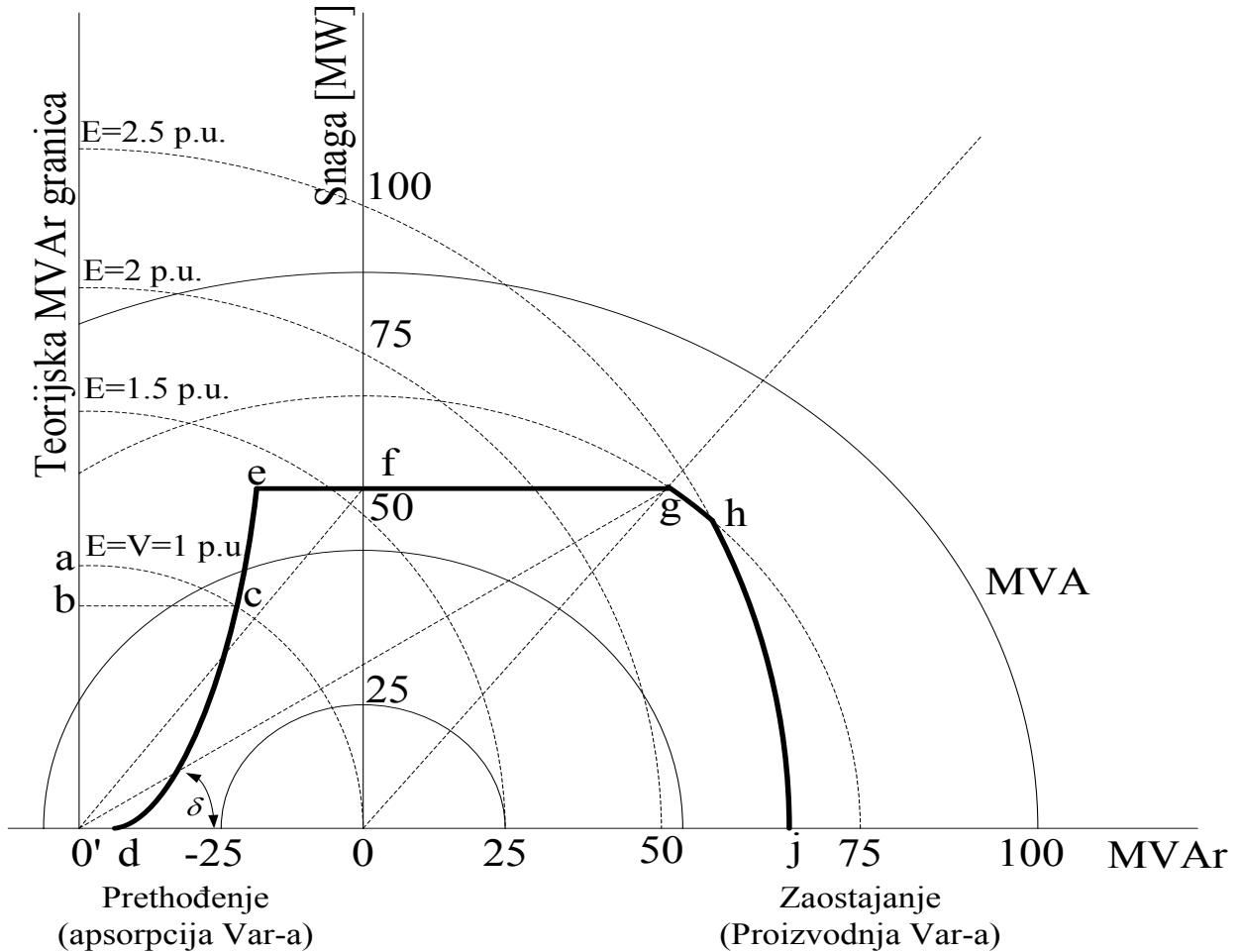
Sl. 3.18 Dijagram proizvodnje sinkronog generatora, [4]
