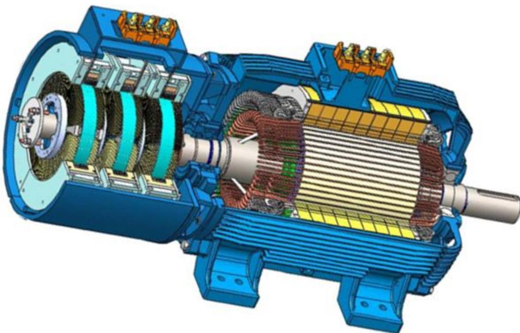
Sl. 4.9 Presjek dvostruko napajanog asinkronog generatora, [12]
