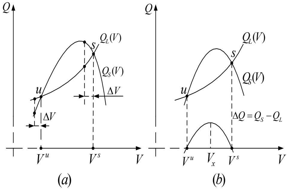
**Sl.2.7**  $Q_S(V)$  i  $Q_L(V)$  karakteristike: (a) dvije ravnotežne točke; (b) ilustracija kriterija stabilnosti,
