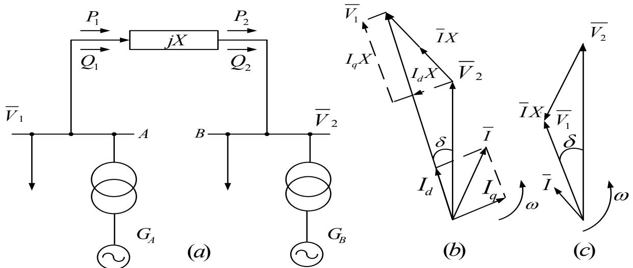
**Sl. 2.3** (a) Interkonekcijska veza dva generatora, (b) fazorski dijagram kada je  $\overline{V_1} > \overline{V_2}$ , (c)
