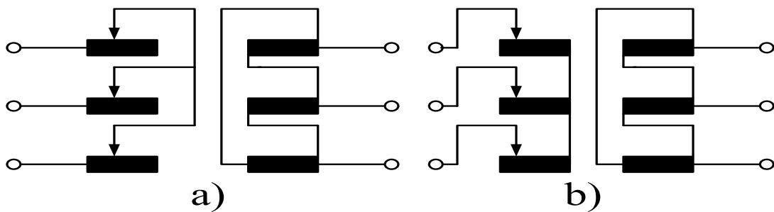
Sl. 3.7 a) regulacijska preklopka u zvjezdništu, b) regulacijska preklopka među fazama, [6]
