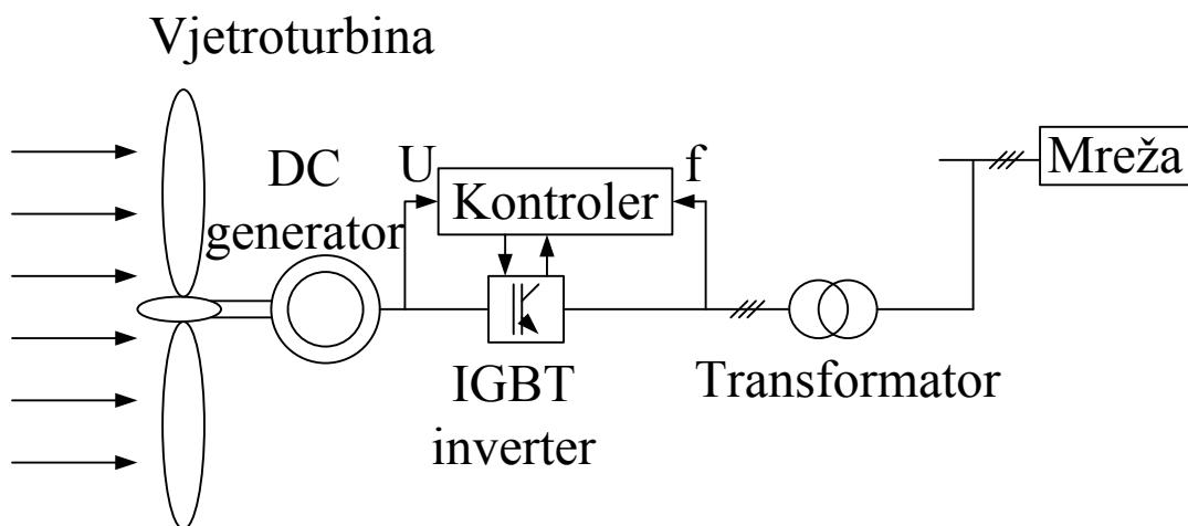
Sl. 4.4 Shematski prikaz istosmjernog generatorskog sustava, [12]
