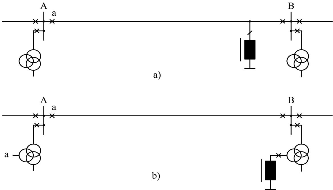
**Sl. 3.21** Kompenzacijkska prigušnica: a) priključena direktno na vod, b) priključena na tercijar transformatora, [1]
