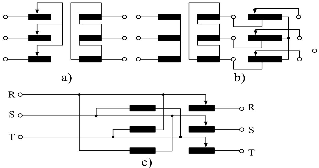
Sl. 3.8 Uzdužna i poprečna regulacija napona transformatora, [6]
