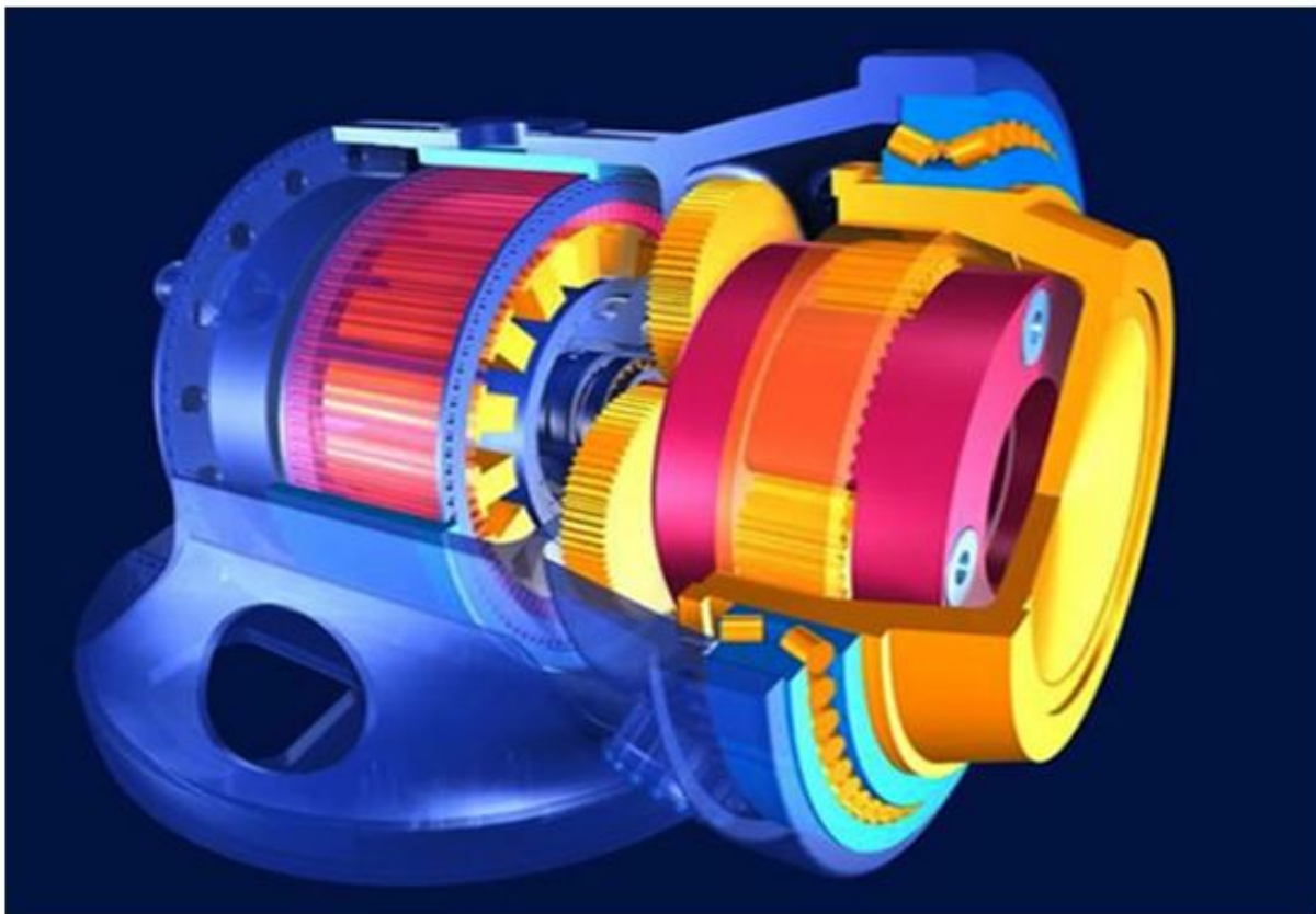
Sl. 4.6 Presjek generatora s permanentnim magnetima, [12]
