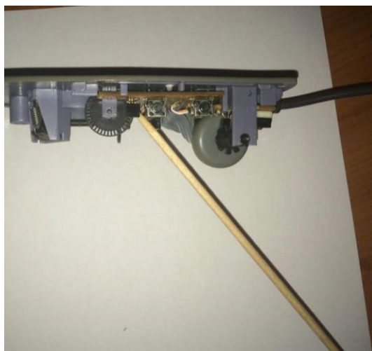
Sl. 2.3. Prikaz miša sa pričvršćenim drvenim štapićem i izgled njihala
