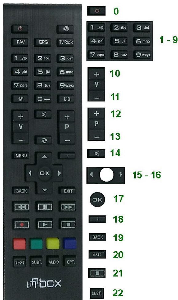
Slika 3.7 Daljinski upravljač s naznačenim tipkama koje imaju funkcionalnost
