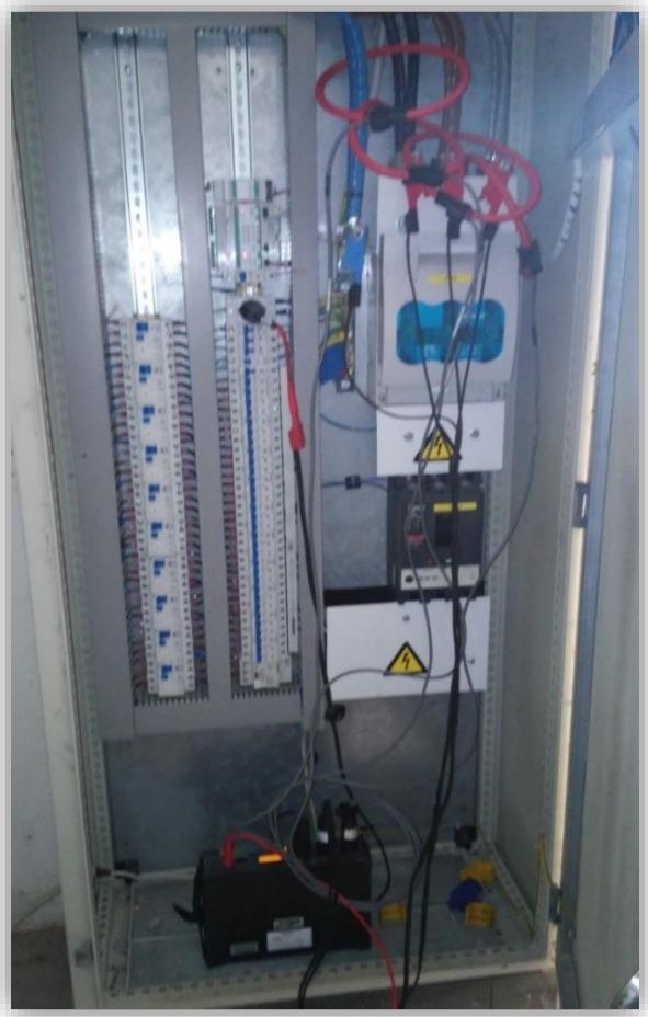
**Slika 4.2.** Uredaj Fluke 1745 spojen u GRO fotonaponske elektrane.
