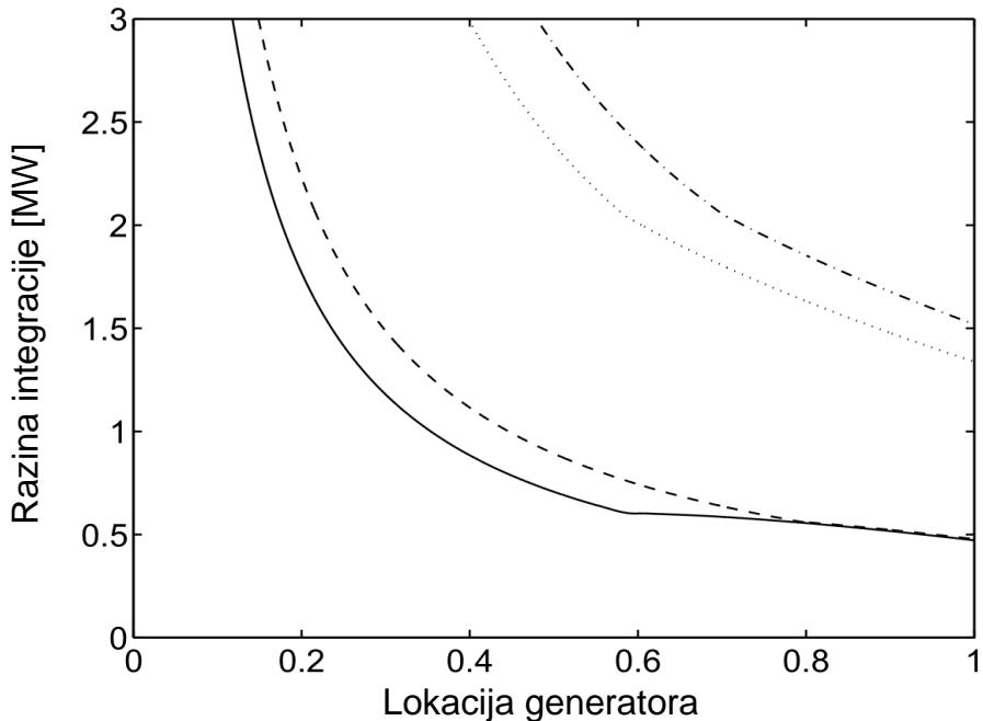
**Grafikon 3.10.** Razina integracije za generator spojen na izvod kao funkcija poprečnog presjeka izvoda, s lijeva na desno:  $95 \text{ mm}^2$ ,  $120 \text{ mm}^2$ ,  $150 \text{ mm}^2$ , i  $180 \text{ mm}^2$
