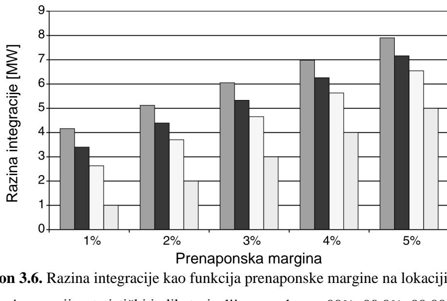
**Grafikon 3.6.** Razina integracije kao funkcija prenaponske margine na lokaciji s visokom razinom integracije, statistički indikatori s lijeva na desno: 99%, 99.9%, 99.99%, i 100% vrijednosti napona
