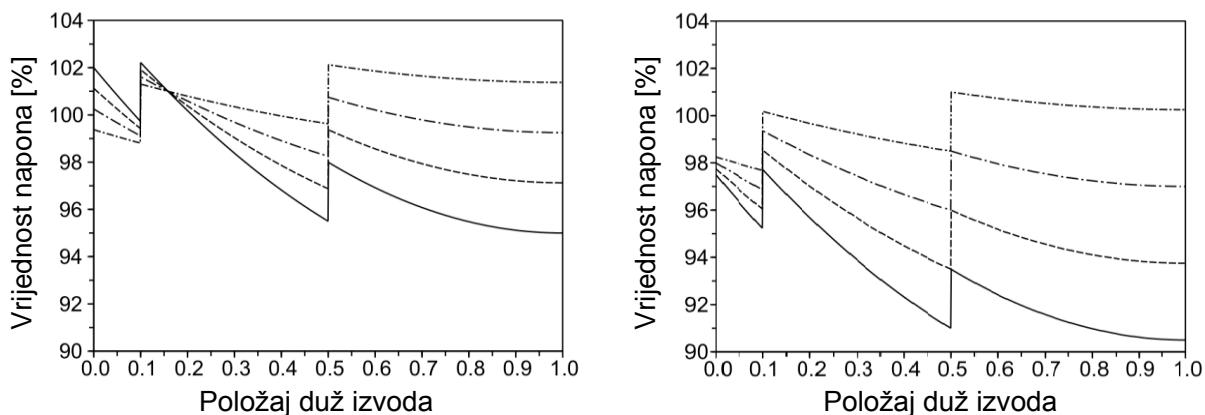
**Grafikon 3.8.** Naponski profil na niskonačunskoj strani distribucijskog transformatora s besteretnim preklopkama (lijevo) i na udaljenoj lokaciji niskonačunske mreže (desno), za izvod bez kompenzacije
