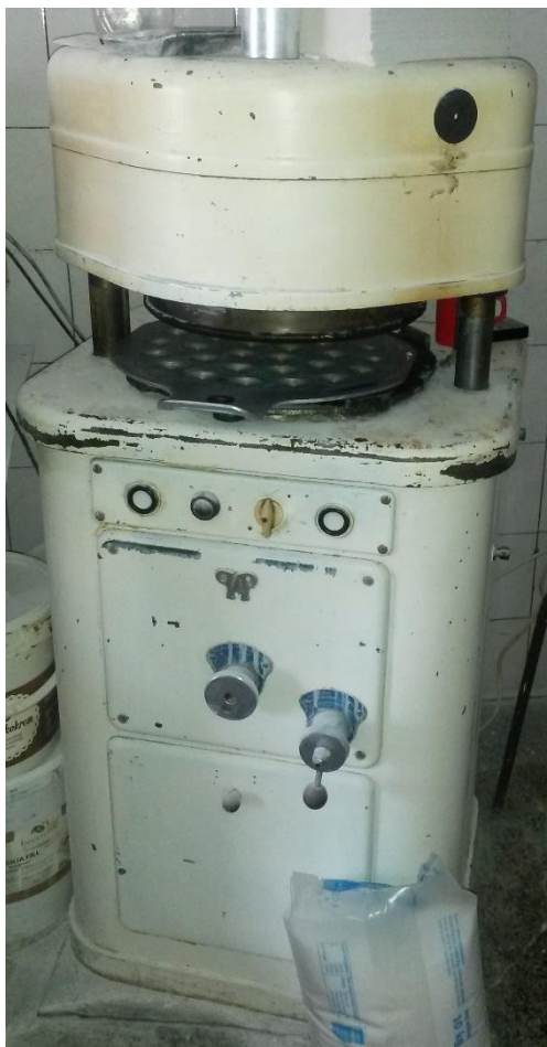
Slika 4.24. Rotamat presa za pravljenje kuglica tijesta
