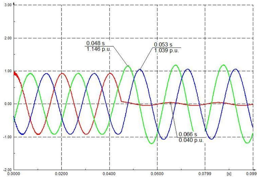
**Sl. 3.25.** Valni oblici napona pojedinih faza na sekundaru 110/35 kV za jednozazni kratki spoj
