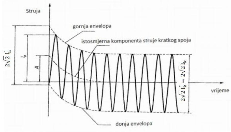
**Sl. 2.1.** Valni oblik struje kratkog spoja kada je kvar daleko od generatora (konstantna izmjenična komponenta)[6]
