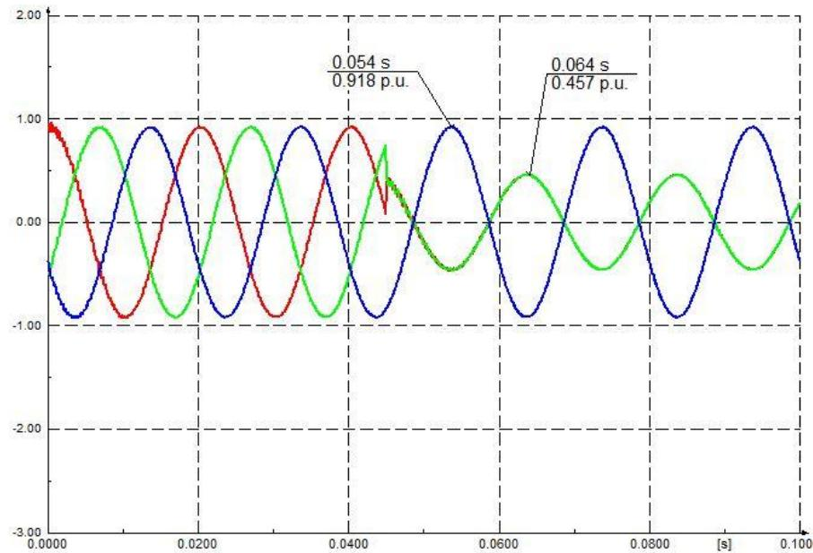
**Sl 3.9.** Valni oblici napona pojedinih faza na primaru za dvofazni kratki spoj
