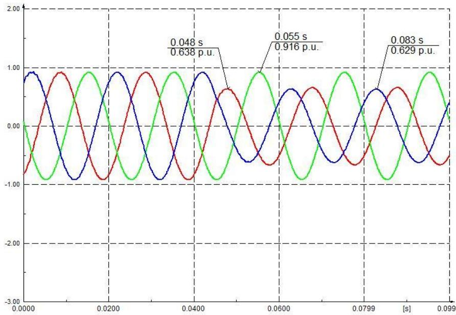
**Sl 3.34.** Valni oblici napona pojedinih faza na sekundaru 35/20 kV za jednofazni kratki spoj
