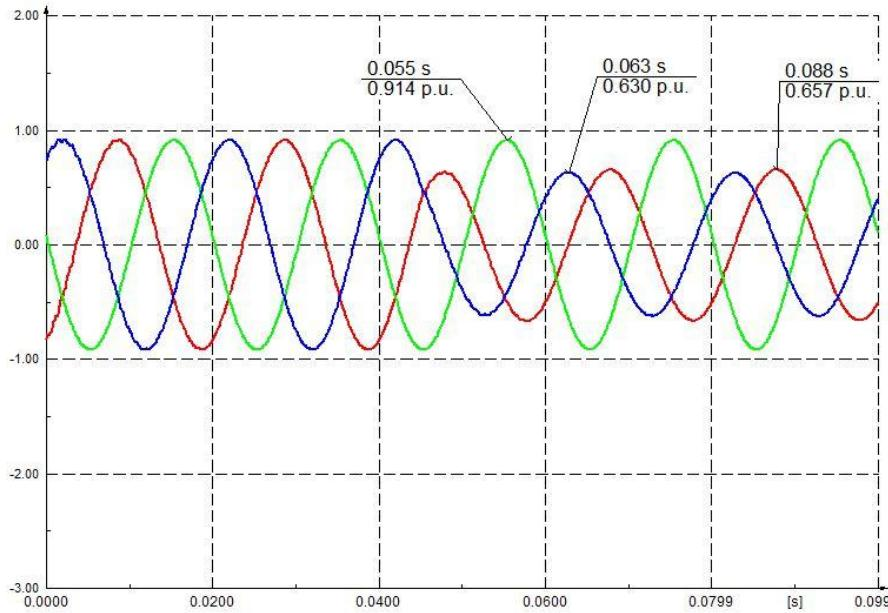
**Sl. 3.28.** Valni oblici napona pojedinih faza na primaru 20/0.4 kV za jednofazni kratki spoj
