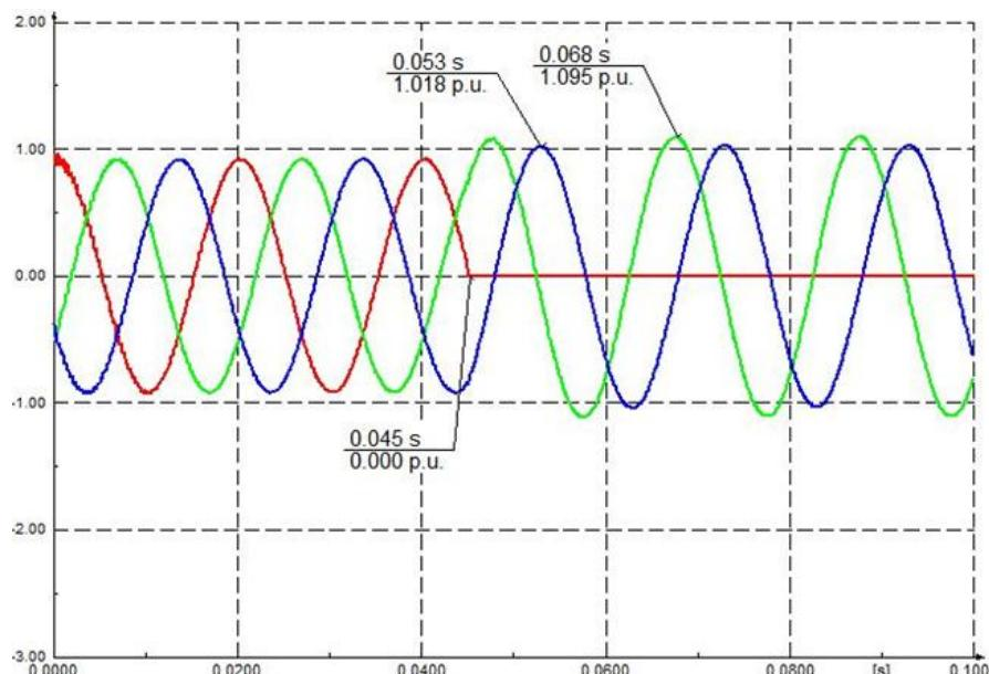
**Sl. 3.11.** Valni oblici napona pojedinih faza na primaru za jednofazni kratki spoj
