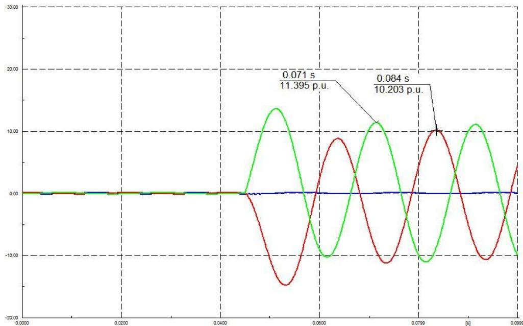
**Sl 3.5.** Valni oblici struja pojedinih faza za dvofazni kratki spoj uz dodir sa zemljom
