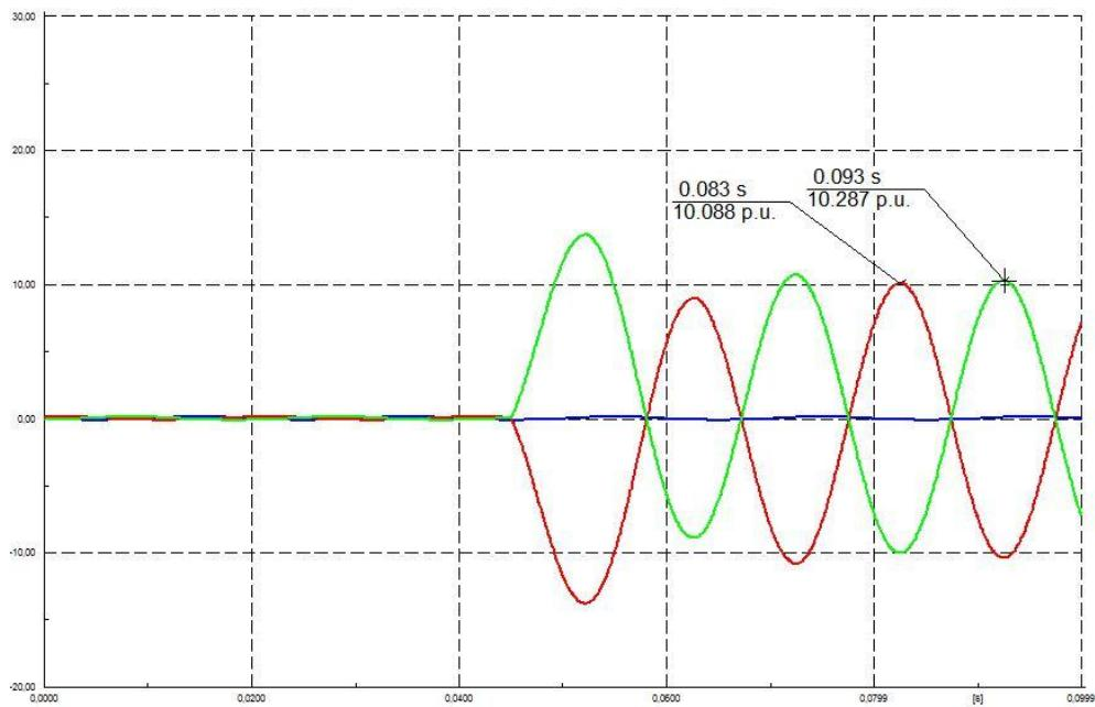
Sl 3.8. Valni oblici struja pojedinih faza za dvo fazni kratki spoj
