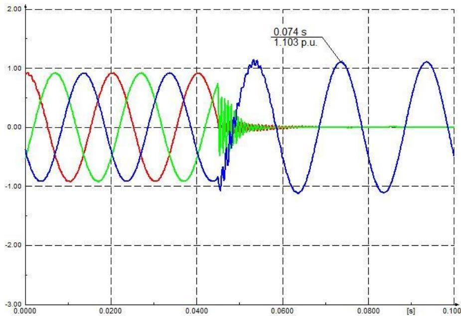
**Sl. 3.7.** Valni oblici napona pojedinih faza na sekundaru za dvofazni kratki spoj uz dodir sa zemljom
