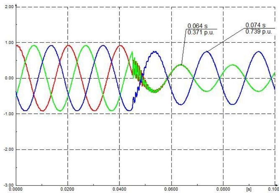
**Sl. 3.14.** Valni oblici napona pojedinih faza na sekundaru za dvofazni kratki spoj uz dodir sa zemljom
