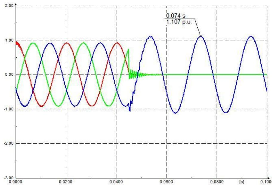
**Sl. 3.6.** Valni oblici napona pojedinih faza na primaru za dvofazni kratki spoj uz dodir sa zemljom
