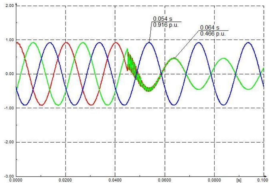
**Sl 3.10.** Valni oblici napona pojedinih faza na sekundaru za dvofazni kratki spoj
