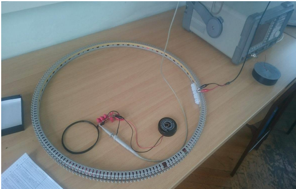
Slika. 4.1.3. Položaj prijemnika u odnosu na predajnik (rub)
