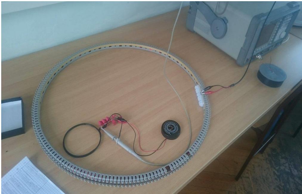
Slika. 4.1.3. Položaj prijemnika u odnosu na predajnik (rub)
