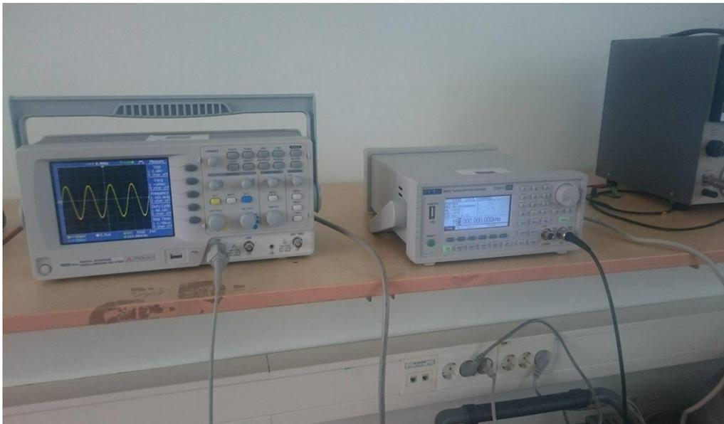
Slika 4.1.1. Osciloskop i funkcijski generator
