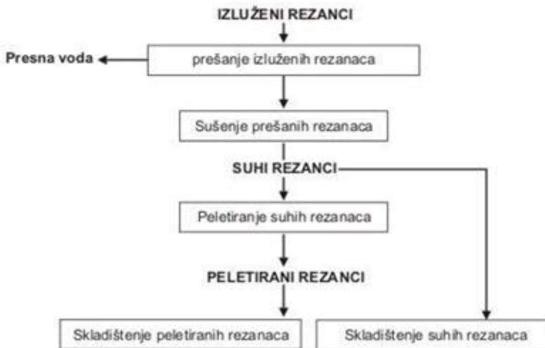
*Slika 3.5. Dijagram procesa obrade rezanaca (preuzeto iz [2])*
