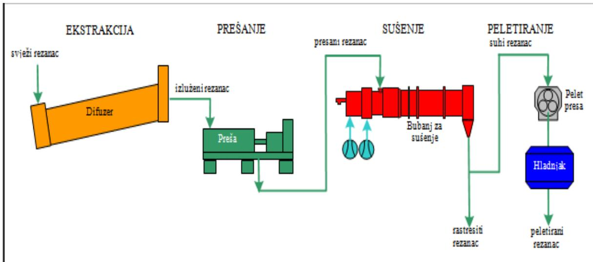
Slika 3.7. Proces obrade repinih rezanaca (preuzeto iz [2])
