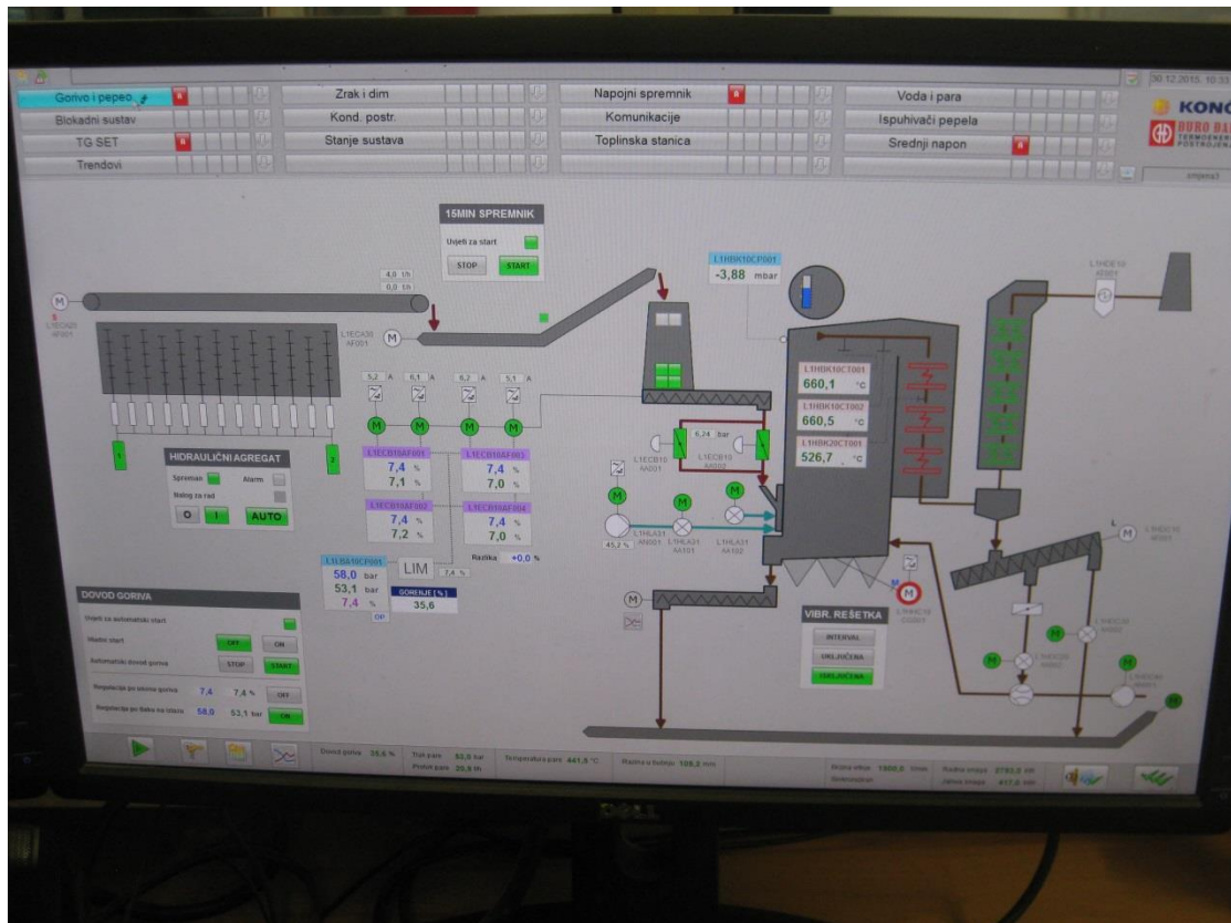
Slika 3.17. Shema procesa goriva i pepela
