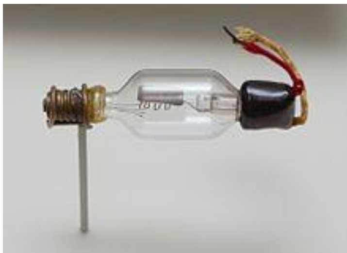
Slika 2.2: Rešetkasti Audion s tri elektrode [2]
